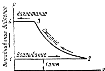
Фиг. 224. Теоретическая диаграмма цикла поршневого компрессора
