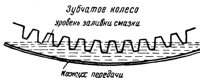
Фиг. 149. Уровень смазки в кожухе
