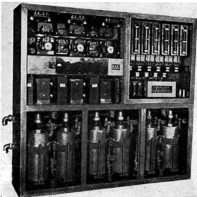
Фиг. 6. Общий вид игнитронной камеры
