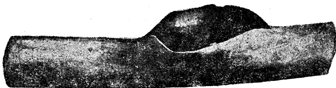
Рис. 10. Разрыв кипяточной трубы—результат сильного перегрева под влиянием силикатной накипи
