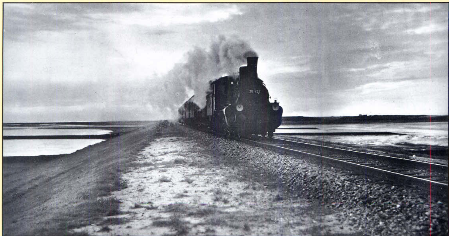
Bild 11: Mit einem Personenzug fährt die 36 427 über den Hindenburgdamm, der die Insel Sylt mit dem Festland verbindet. Die Lokomotive wurde 1909 von Humboldt an die Preussischen Staatseisenbahnen geliefert (Fabrik-Nr. 620), wo sie die Betriebsnummer (P 4) Altona 1933 erhielt. Foto: Sammlung Rauter
