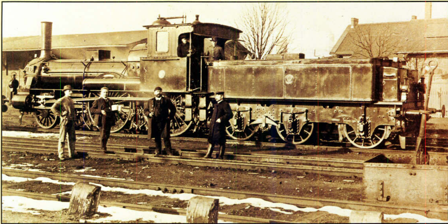
Bild 14: Die "Durchbrenner" der Cöln-Mindener Eisenbahn haben sich als Nachfolger der "Schnellläufer" großartig bewährt. Hier die "Limmat" (Abmessungen: 420/508/1981; 10), die 1872 von Borsig unter der Fabriknummer 2867 gebaut wurde. Sie erhielt 1883 bei der KED Cöln rechtsrheinisch die Betriebsnummer 133, ab 1895 wurde sie als Essen 133 bezeichnet. Als sie im Jahre 1903 ausrangiert wurde, konnte sie auf eine für eine Schnellzuglokomotive lange Dienstzeit von über 30 Jahren zurückblicken. Foto: Sammlung Cramer
