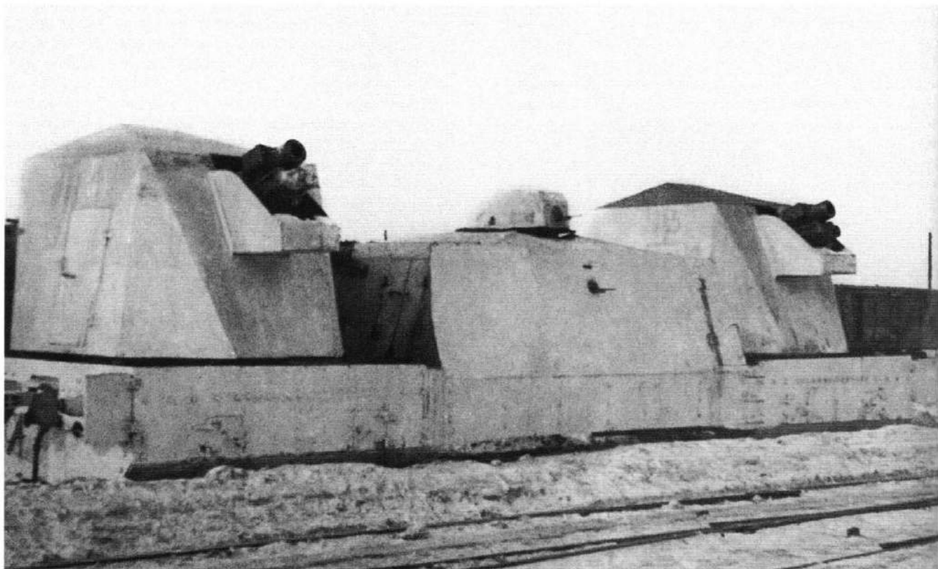
Wagon pancerny pociągu pancernego nr 2 „Kołomieński Robotnik” z 55. Samodzielnego Dywizjonu Pociągów Pancernych wykonany w Zakładach im. Kujbyszewa w Kołomnie w styczniu 1942 roku. An armoured wagon of an armoured train No. 2 nicknamed “Kolomyeysk Worker” from the 55th Independent Armoured Train Battalion manufactured at Plant named after Kuybyshev in Kolomna in January 1942. [ASKM]
