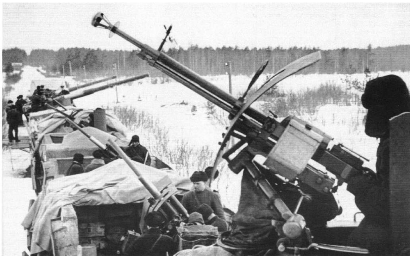
Pociąg pancerny nr 7 „Baltijec” Floty Bałtyckiej Czerwonego Sztandaru w 1942 roku. Widoczne uzbrojenie pociągu, przeciwlotniczy karabin maszynowy DSzK, armata 21-K i morskie armaty kalibru 102 mm. An Armoured Train No. 7 “Baltyetsh” belonged to the Red Banner Baltic Fleet in 1942. Note armoured train was armed with DShK machine guns, 21-K guns and 102mm calibre naval cannons. [CMWS]
