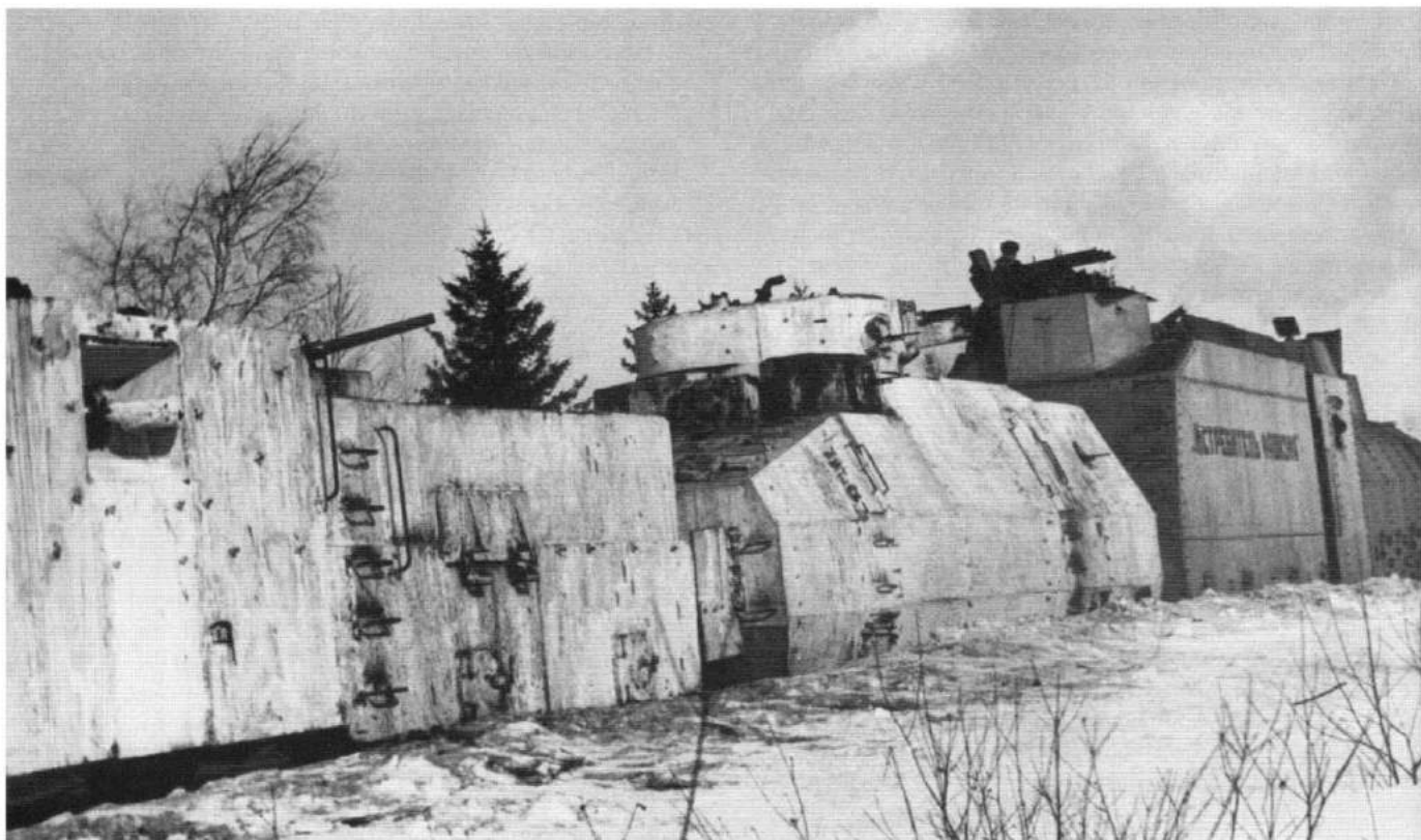
Pociąg pancerny nr 1 „Niszczyciel Faszyzmu” z 6. Samodzielnego Dywizjonu Pociągów Pancernych wykonany w warsztatach w Lublińsku w listopadzie 1941 roku. Na pierwszym planie wagon przeciwlotniczy uzbrojony armatami przeciwlotniczymi kalibru 76,2 mm, dalej wagon pancerny z kadłubem i wieżą czołgu T-28. An armoured train No. 1 nicknamed “Destroyer of Fascism” from the 6th Independent Armoured Train Battalion manufactured at railway works in Lublińsk in November 1941. In the foreground is an AA defence wagon armed with 76.2mm calibre AA guns and next an artillery wagon with a hull and a turret of the T-28 tank. [ASKM]
