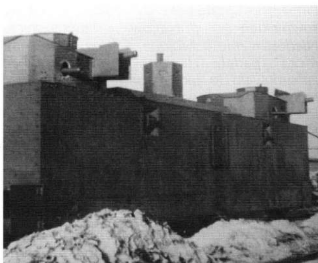
Lekki wagon pancerny PL-35 z opancerzeniem typu składu wojskowego nr 60 wyprodukowany w 1934 roku. Light armoured wagon PL-35 manufactured in 1934 with armor designed at Military Depot No. 60. [ASKM]
