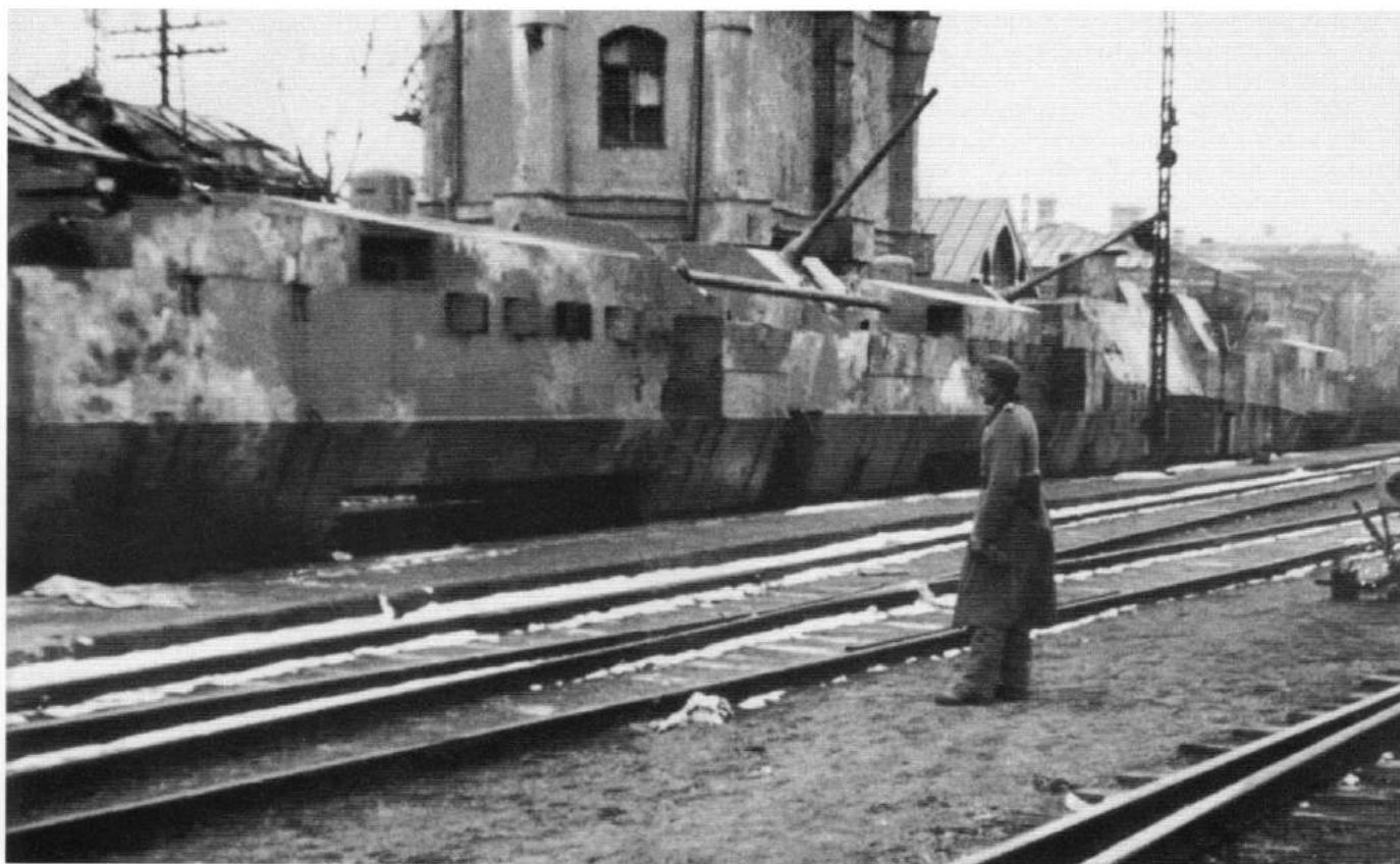
Pociąg pancerny (prawdopodobnie „Wojkowiec”) na stacji w Symferopolu jesienią 1942 roku. Widoczny wagon pancerny uzbrojony w armaty uniwersalne 34-K kalibru 76,2 mm. An armoured train (probably “Voykoviec”) seen in Symferopol, Autumn 1942. Note armoured wagon armed with 76.2mm calibre 34-K universal guns. [ASKM]
