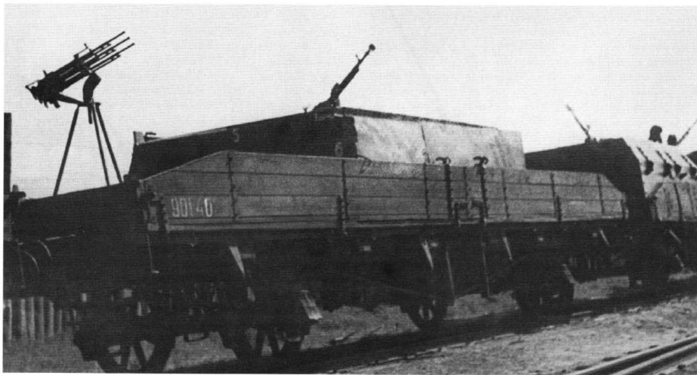
Platforma obrony przeciwlotniczej pociągu pancernego nr 1 z 49. Samodzielnego Dywizjonu Pociągów Pancernych uzbrojona w karabin maszynowy DSzK i potrójnie sprzężony DT. Dalej wagon obrony przeciwlotniczej wyprodukowany przez zakłady „Stalmost”. An AA defence flatcar armed with a DShK machine gun and triple DT machine guns attached to the No. 1 armoured train from the 49th Independent Armoured Train Battalion. In the background is an armoured AA defence wagon manufactured by “Stalmost”. [ASKM]
