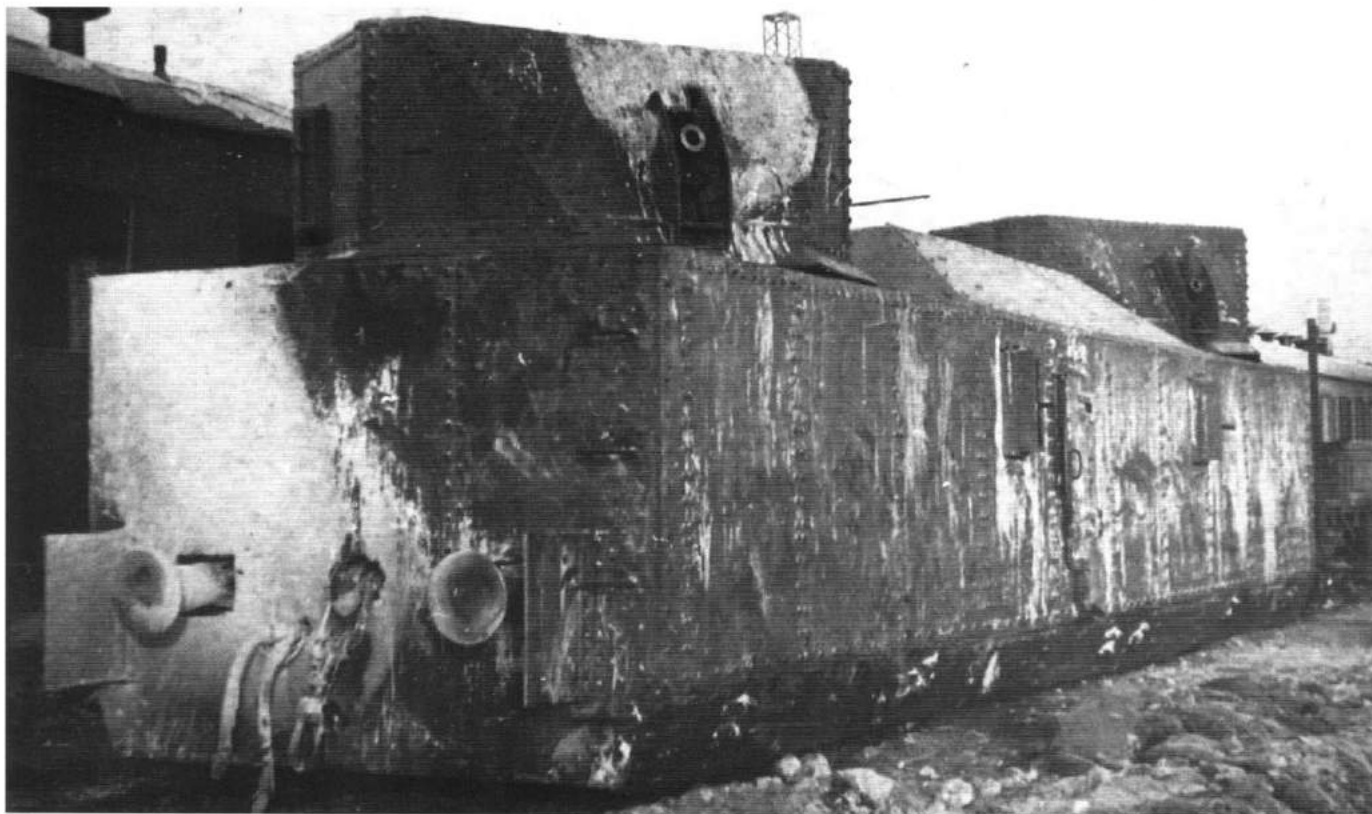
Wagon pancerny NKPS-42 pociągu pancernego nr 1 z 50. Samodzielnego Dywizjonu Pociągów Pancernych wykonany w Zakładach Naprawy Parowozów w Jarosławiu w styczniu 1942 roku. Uzbrojenie stanowiły dwie armaty pułkowe wzór 1927 kalibru 76,2 mm i sześć polskich karabinów maszynowych Browning wzór 28. An armoured wagon of an armoured train No. 1 attached to the 50th Independent Armoured Train Battalion manufactured at Locomotive Repair Plant in Yaroslavl in January 1942. Wagon was armed with two 76.2mm calibre Model 1927 regimental guns and six ex-Polish Browning Model 1928 machine guns. [CAMO]
