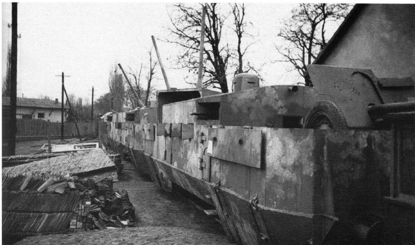
Pociąg pancerny (prawdopodobnie „Wojkowiec”) używany na Krymie. Widoczny wagon pancerny uzbrojony w armatę F-22, armatę 34-K i armatę Hotchkiss kalibru 37 mm w zabudowaną kazamacie. An armoured train (probably "Voykoviec") used on Crimea. Note armoured wagon armed with a F-22 gun, a 34-K gun and a Hotchkiss 37mm calibre gun mounted in casemate. [A. Piastowski]
