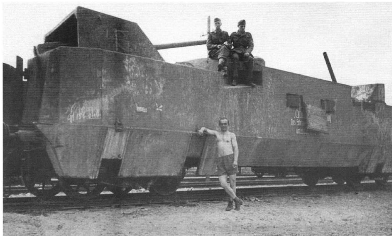
Zdobyty przez Niemców wagon pancerny uzbrojony w dwie armaty uniwersalne 34-K i karabiny maszynowe w kazamatach bocznych i narożnych. A captured by the Germans armoured wagon armed with two 34-K universal guns and machine guns mounted on the sides and corners of the wagon. [ASKM]
