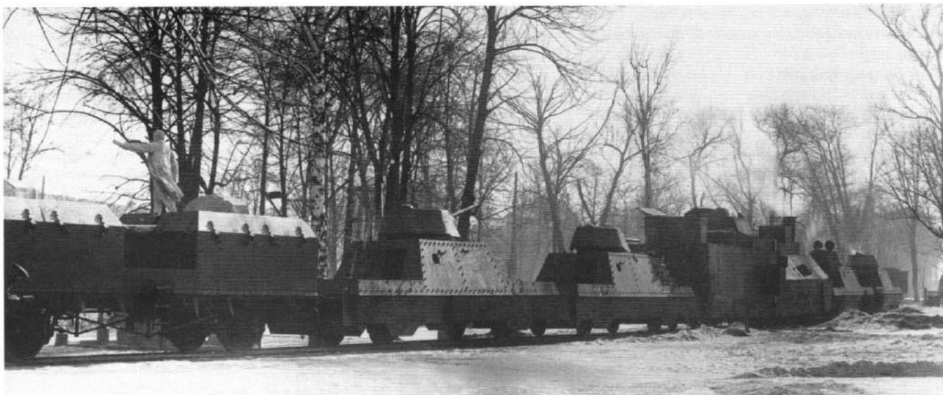
Drugi pociąg pancerny BP-43 wykonany w zakładach im. Kujbyszewa w Kołomnie w lutym 1943 roku, na pierwszym planie wagon pancerny obrony przeciwlotniczej PWO-4. The second BP-43 armoured train manufactured in Plant named after Kyjbyshew in Kolomna in December 1942. In the foreground is a PVO-4 AA defence armoured wagon. [ASKM]
