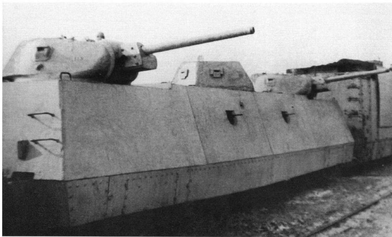
Wagon pancerny pociągu pancernego „ Kuźma Minin ” z 31. Specjalnego Dywizjonu Pociągów Pancernych ze spawanym opancerzeniem o grubości 45 mm. An armoured wagon of an armoured train nicknamed “ Kushma Minin ” from the 31st Special Armoured Train Battalion fitted with welded 45mm thick armour. [ASKM]
