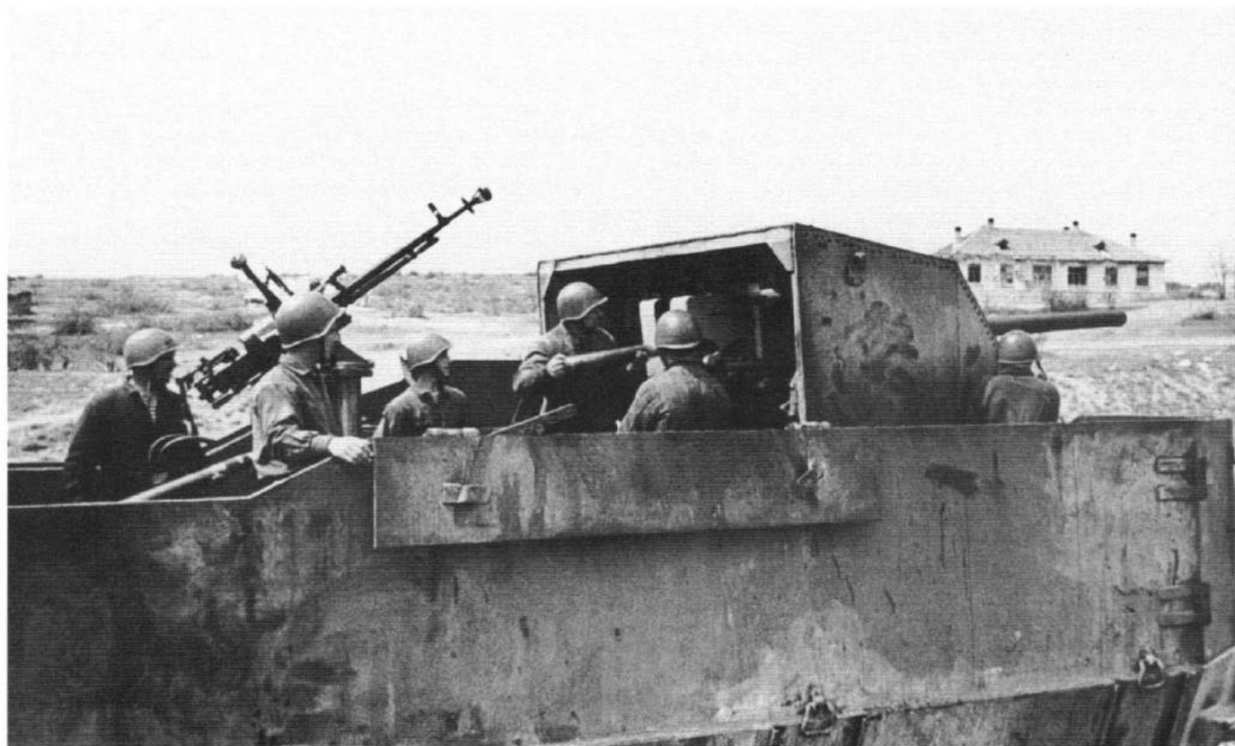
Załoga wagonu pancerneho z pociągu pancerneho „ Żeleznikow ” w akcji w maju 1942 roku. Widoczna armata uniwersalna 34-K kalibru 76,2 mm i przeciwlotniczy karabin maszynowy DSzK . The crew of an armoured wagon of armoured train „ Sheleshnyakov ” in action in May 1942. Note armoured wagon armed with an 76.2mm calibre 34-K universal gun and a DShK AA machine gun. [ASKM]
