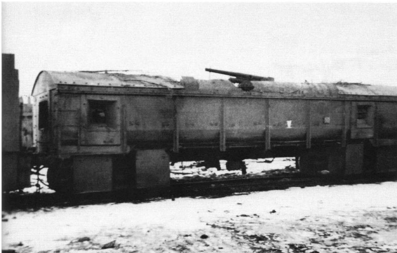
Wagon pancerny, wykonany z węglarki, zdobyty przez Niemców jesienią 1941 roku, uzbrojony w armatę plot. Lender wzór 1914/1915 kalibru 76,2 mm i pięć karabinów maszynowych. Być może ten wagon wchodził w skład pociągu pancernego wykonanego w Kijowie. A captured by the Germans in Autumn 1941 armoured wagon made from cool-wagon armed with an 76.2mm calibre Lender Model 1914/1915 AA gun and five machine guns. Wagon probably belonged to the armoured train built in Kiev. [ASKM]
