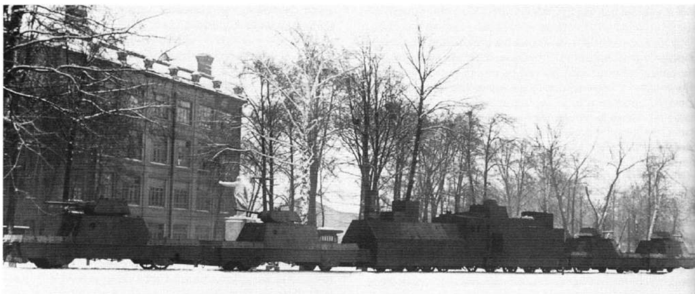
Pierwszy pociąg pancerny BP-43 wykonany w zakładach im. Kujbyszewa w Kołomnie w grudniu 1942 roku, widoczne różne typy wież czołgów T-34 zamontowanych w wagonach pancernych PL-43. The first BP-43 armoured train manufactured in Plant named after Kyjbyshew in Kolomna in February 1943. Note various types of the T-34 tank turrets in PL-43 armoured wagons. [ASKM]
