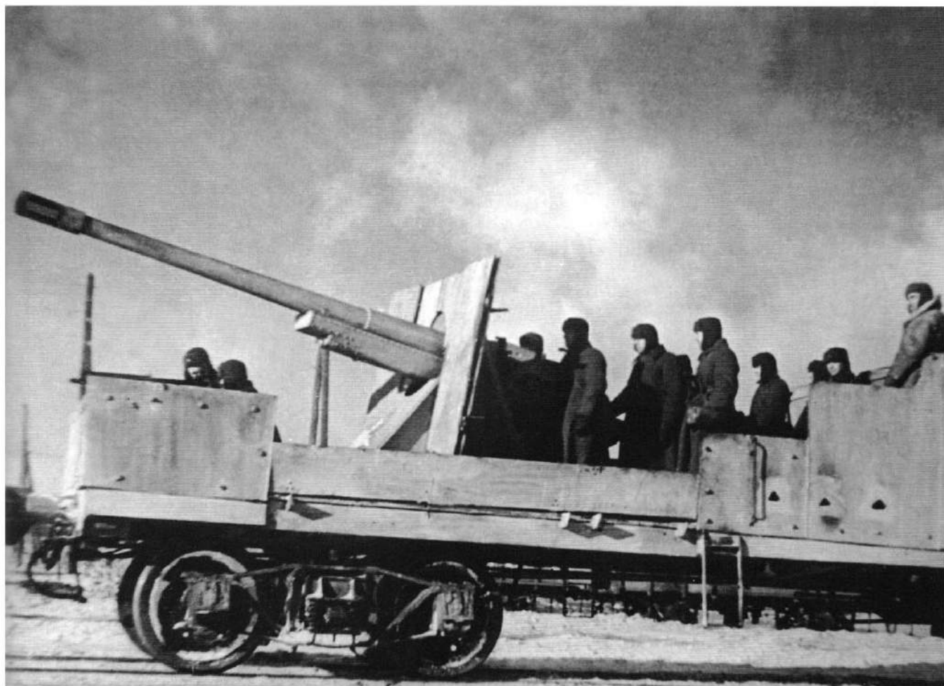
Platforma z armatą wzór 1910/30 kalibru 107 mm specjalnego pociągu pancernego nr 2 „Za Ojczyznę”, zima 1942 roku. An armoured flatcar armed with an 107mm calibre Model 1910/30 gun from a special armoured train No. 2 “For Motherland”, Winter 1942. [CMWS]
