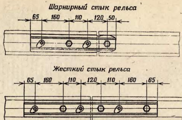
Рис. 44. Стыковые рельсовые накладки
