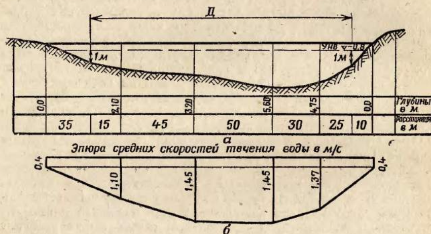
Рис. 79. Продольный профиль перехода и эпюра скоростей течения:
