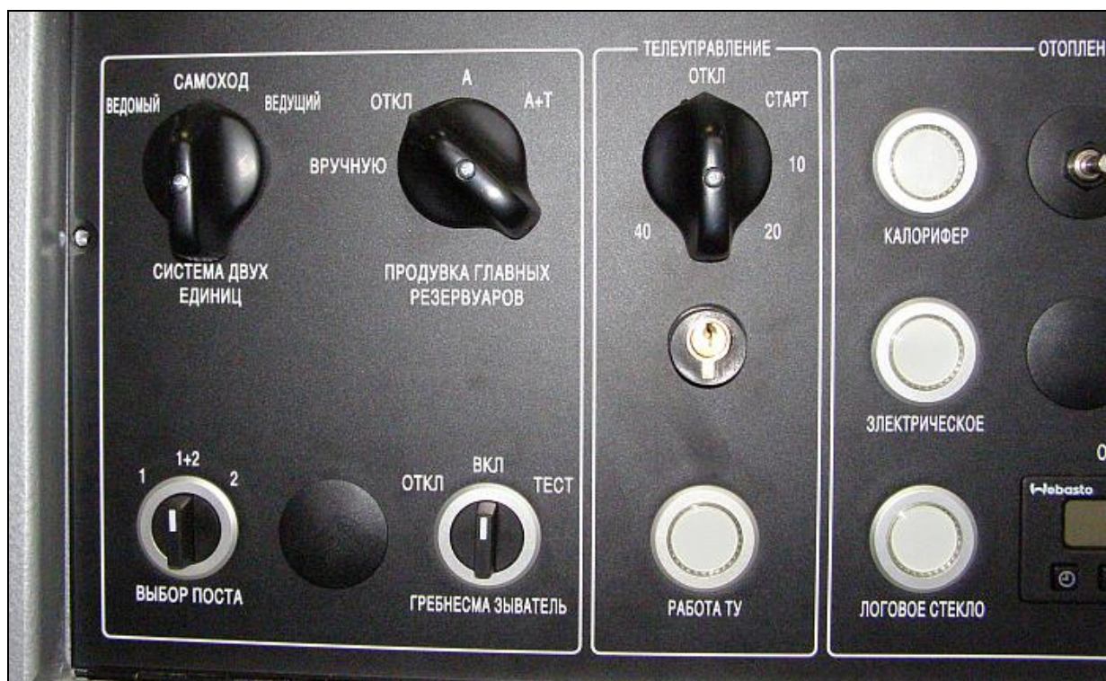
рис. 49: Левая часть панели электрораспределителя R2
