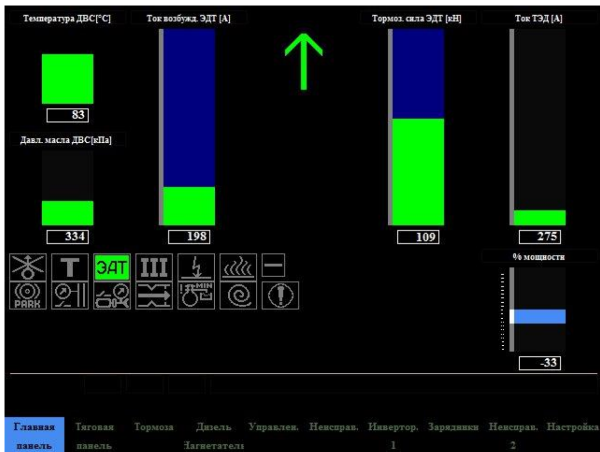
рис. 28: Отображение на дисплее в режиме электродинамического тормоза.
