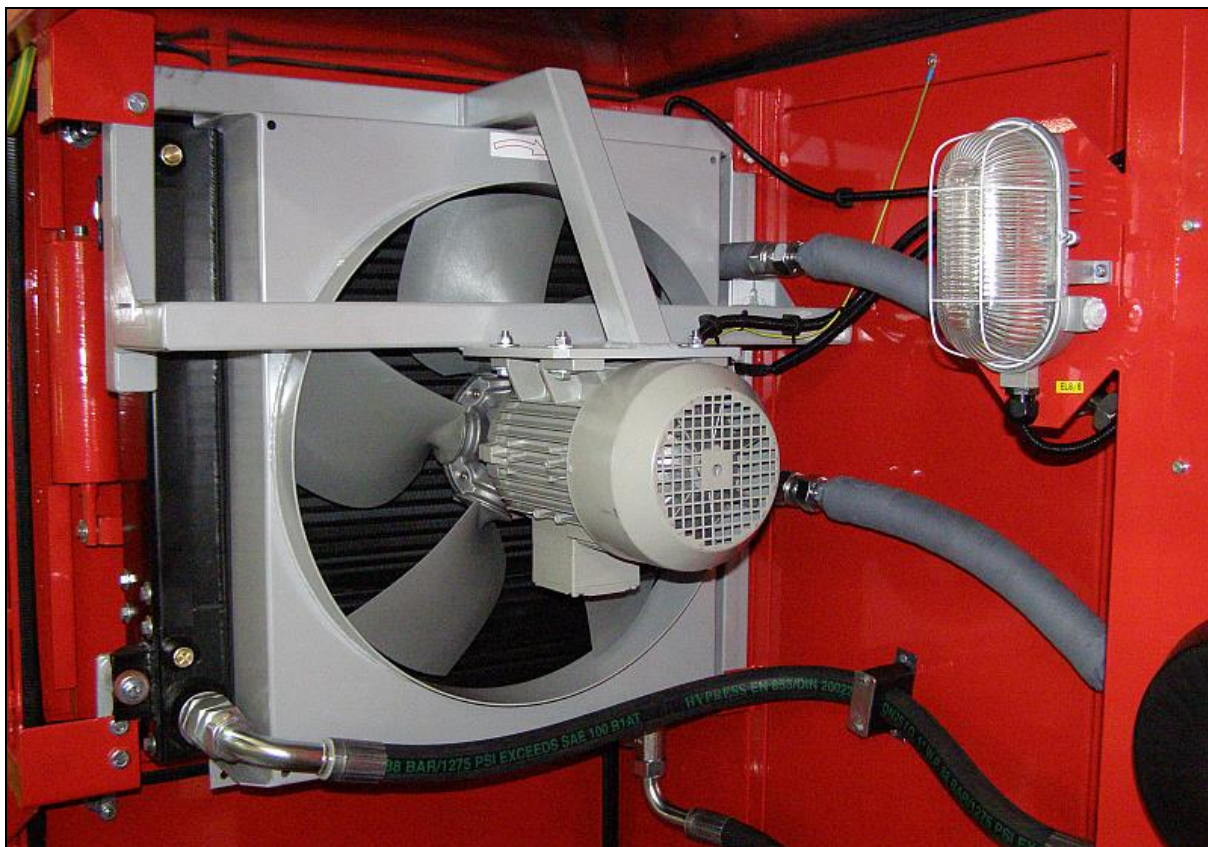
рис. 6: Охладитель воздуха и масла компрессора
