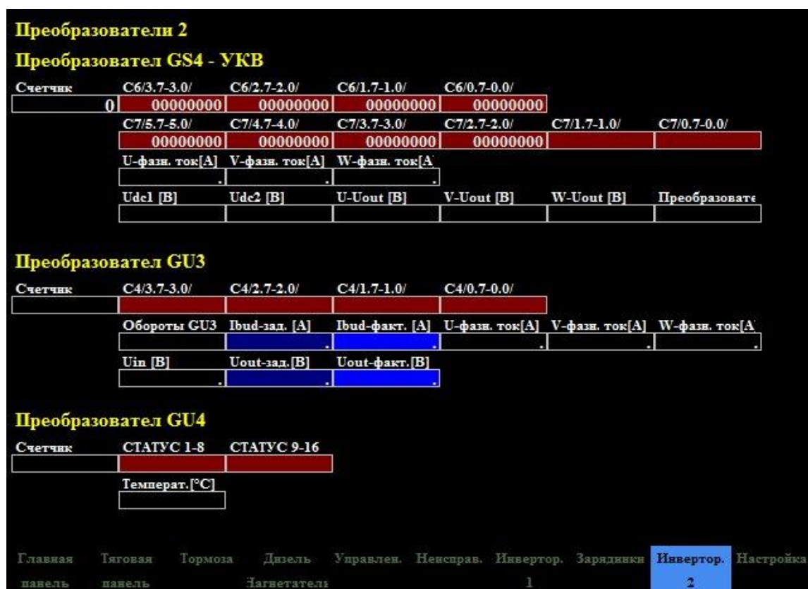
рис. 37: Отображение информации на экране дисплея при выборе закладки «Инверторы 2» на нижнем ряду клавиатуры
