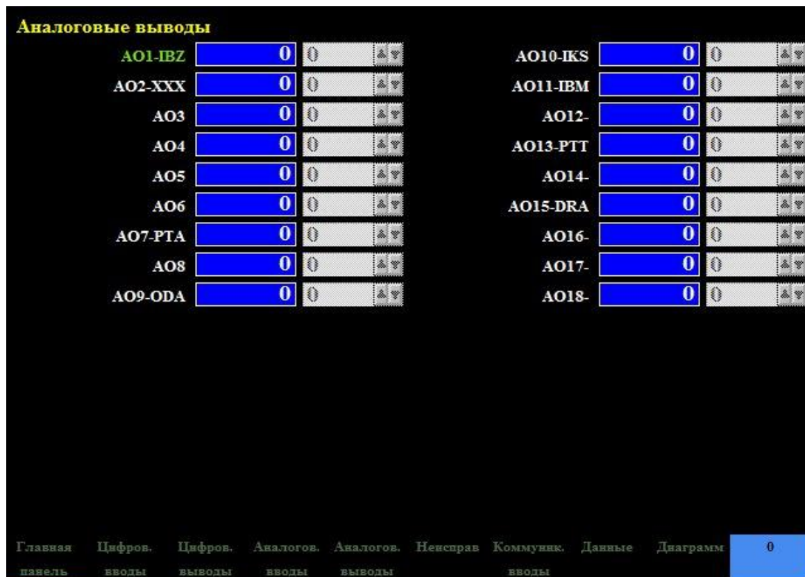
рис. 42: Отображение информации на экране дисплея при выборе закладки «Аналоговые выходы» на нижнем ряду клавиатуры
