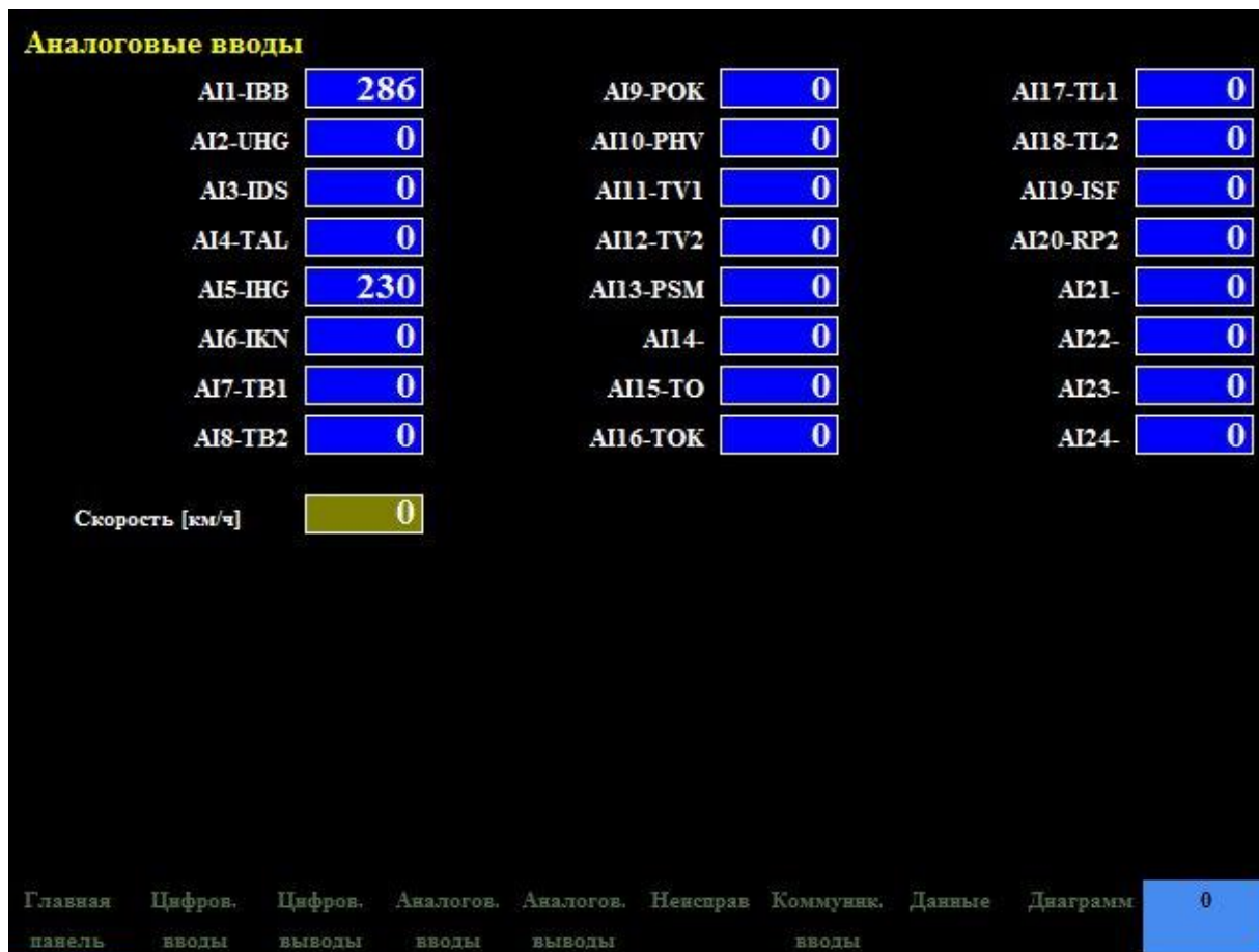
рис. 41: Отображение информации на экране дисплея при выборе закладки «Аналоговые входы» на нижнем ряду клавиатуры
