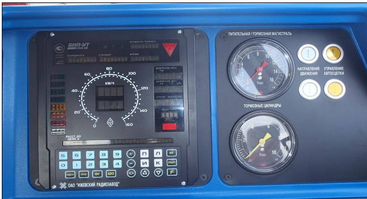
рис. 46: Пульт управления машиниста – правая панель
