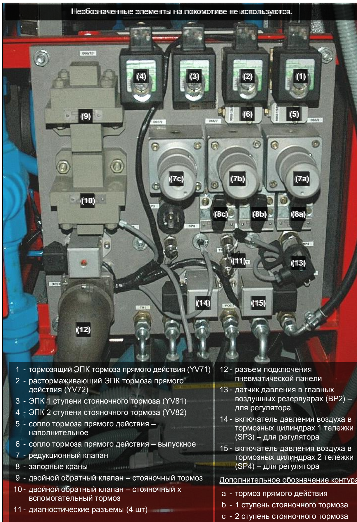
рис. 16: Тормозная панель прямодействующего и стояночного тормозов – ДАКО 90800-066
