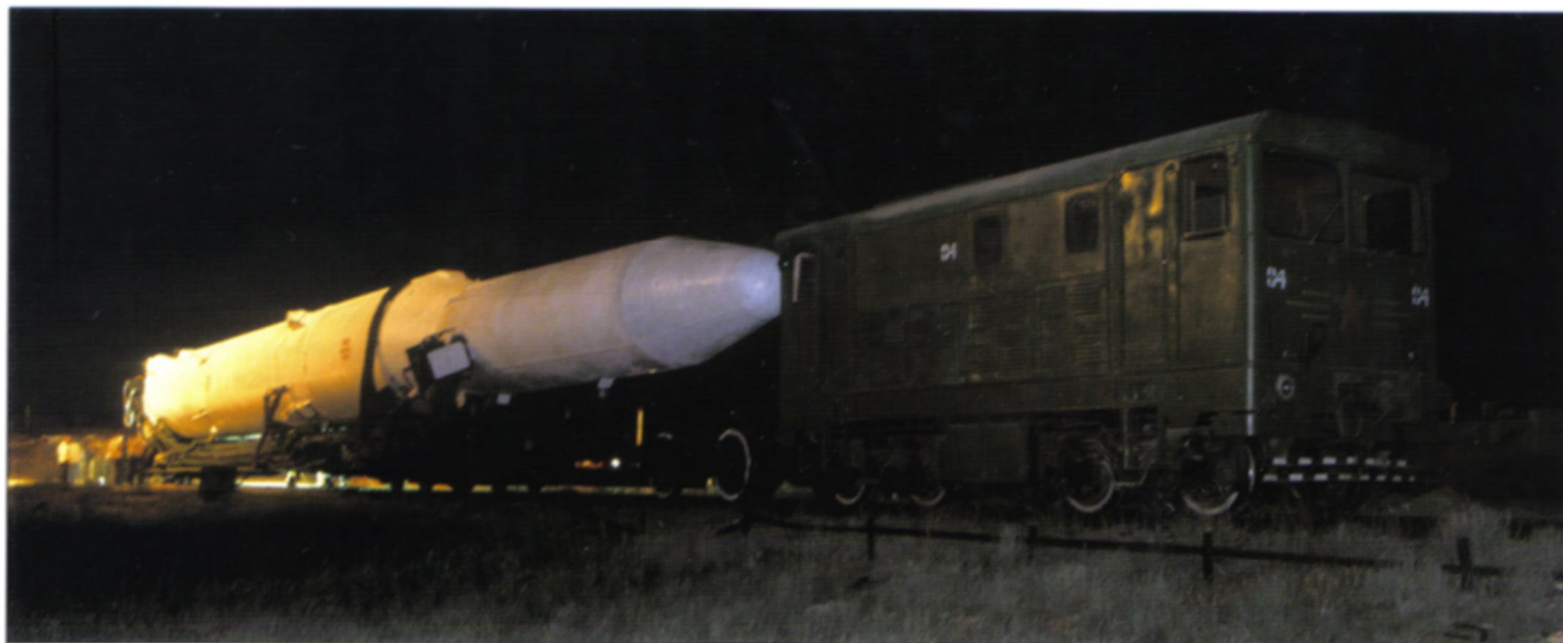
Агрегат 11Т125 доставляет на стартовую позицию ракету-носитель «Циклон-2» с космическим аппаратом перед запуском с космодрома Байконур. 28 мая 2004 года. Фото предоставлено издательством «Рестарт».
