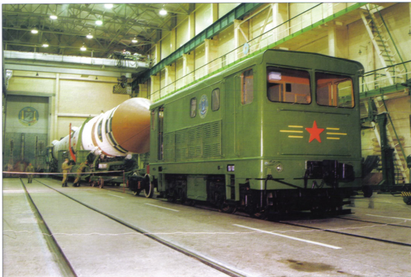
Агрегат 11Т125 выпуска 1990 года с измененным кузовом, унифицированным с кузовом агрегата 11Т186, в монтажно-испытательном корпусе перед запуском космического аппарата «Коронас-Ф» ракетой-носителем «Циклон-3» с космодрома Плесецк. 31 июля 2001 года. Фото А. Гринченко, предоставлено издательством «Новости космонавтики».
