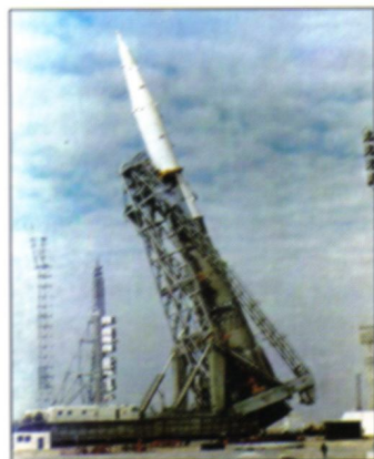
Установка ракеты-носителя Н1 (11А52) на стартовую позицию. Фото из коллекции автора.
