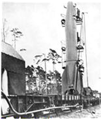
Фото 13. Ракета А-4 (ФАУ-2) на железнодорожной пусковой установке
