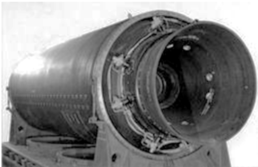
Фото 18. Твердотопливный двигатель 15Д206 первой ступени ракет 15Ж44, 15Ж52, 15Ж61. В сопле видны клапаны системы вдува газа
