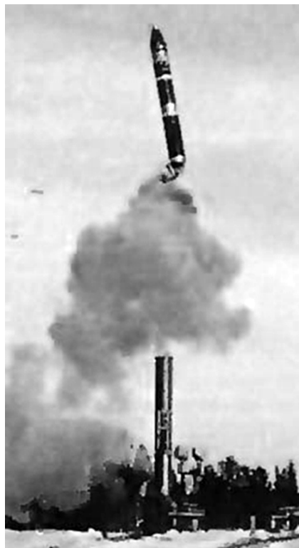
ФОТО 24. Ракета 15Ж52 выполняет маневр «заклона» перед запуском маршевого двигателя 1-й ступени. После выхода из транспортно-пускового контейнера ракета наклонилась под воздействием установленного на поддоне ракеты специального двигателя. После этого пиротехника отрубил поддон, и он уводился в сторону. Затем включался маршевый двигатель
