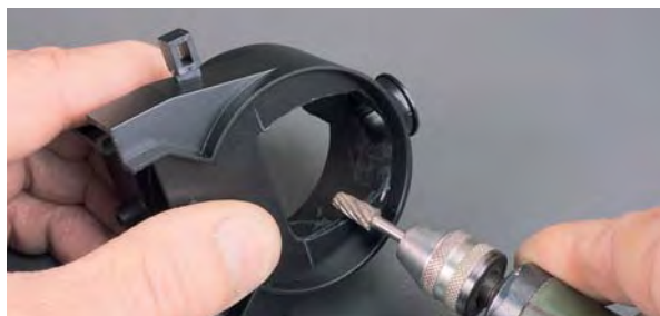
Mit einem Fräseinsatz im Minischleifer ist die Aussparung in der Trennwand schnell hergestellt.
