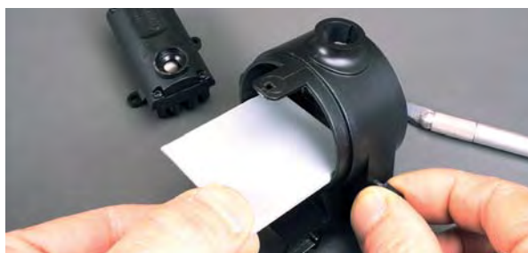
Zur Befestigung des Dampfaggregats muss eine Trägerplatte eingesetzt werden. Sie besteht aus 3 mm starkem Kunststoffmaterial.
