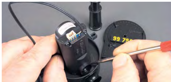
Für die richtige Position des Verdampfers muss die Rauchkammer bearbeitet werden. An dem Kunststoffteil ist das einfach möglich.
