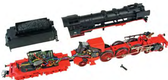
Nach dem Abnehmen der Gehäuse offenbart sich die verbaute Technik mit dem Märklin Trommelkollektormotor in der Lok und der Delta-Steuerlektronik im Tender.
