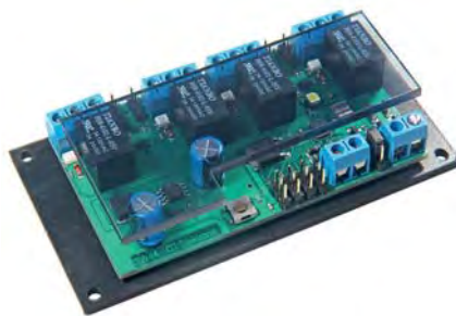
Der SW45 von cT Elektronik löst demnächst den aktuellen SW4 ab. Beide sind 4-fach-Decoder mit intergrierten Relais.
