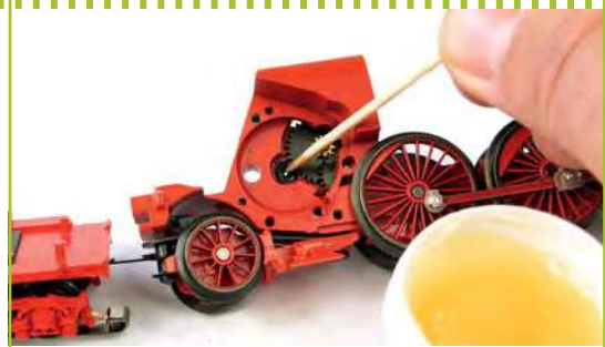
Nach Reinigung aller beweglichen Teile werden Zahnräder und Lagerungen wieder geschmiert.
