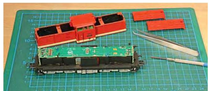
Einbau der neuen Platine ohne weitere Einbauten
