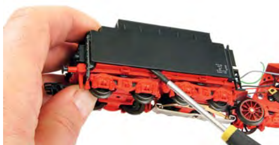
Der Tender besitzt keine Montageschraube. Er wird mit einem Schraubendreher vorsichtig von unten aufgehebelt.
