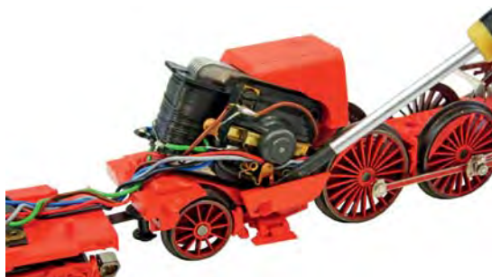
Um an die untere Befestigungsschraube des Motorschilds zu kommen, muss die Verkleidung vorsichtig abgehebelt werden.
