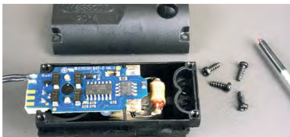
In dem Gehäuse des Raucherzeugers ist die Decoderplatine mit dem Lüftermotor untergebracht. Vor der Platine sind die Heizelemente erkennbar.
