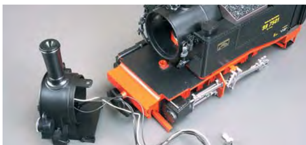
Die Rauchkammer ist hier als separates Bauteil ausgeführt. Das erleichtert die Umrüstarbeiten deutlich.
