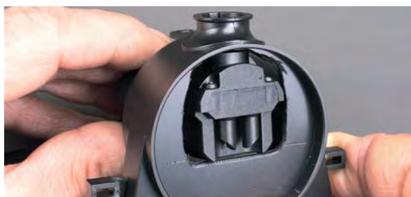
Das Ergebnis der Fräsaktion wird überprüft. Die beiden Austrittsöffnungen sollten miteinander fluchten.
