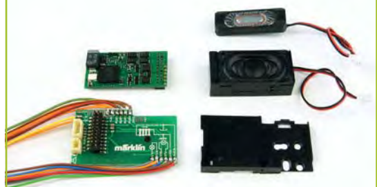
Der mSD3 bringt eine mit Kabeln versehene Adapterplatine, eine isolierende Halterung und zwei Lautsprecher mit.
