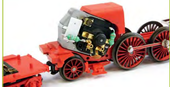
Der neue Motor sitzt an seinem Platz. Entstördrosseln und Masseverbindung (Lötflanke oben links) nicht vergessen! Der Keramikcondensator wird später noch umgebogen.
