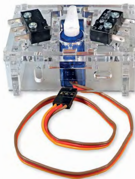
Ein Servo als Antrieb für Bewegungen, an deren Endpunkten elektrische Kontakte zu verbinden sind – z.B. eine Weichenbetätigung mit Herzstückpolarisierung
