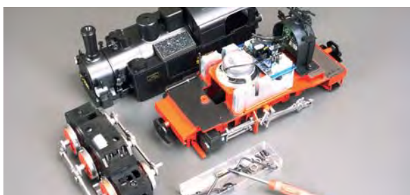
Für den Einbau des Verdampfers muss das Modell in seine wichtigsten Baugruppen zerlegt werden. Im Falle der IK ist das recht einfach zu machen.
