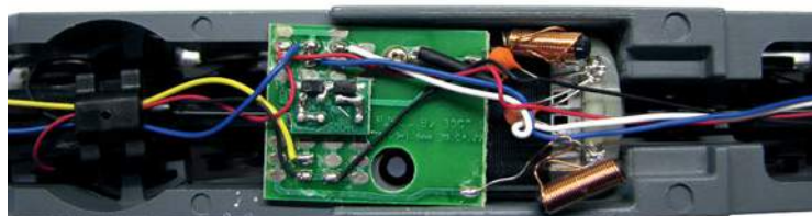
Beim Piko-Herkules wird die eingebaute Leiterplatte ersetzt, egal, ob diese bereits eine NEM-652-Schnittstelle trägt oder nicht.
