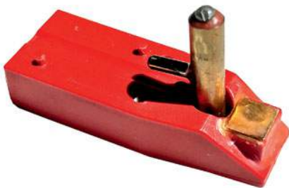
An der Unterseite des Dampfsammelkastens wird die Öffnung, durch die der Dampf in das „umgekehrte Y“ geleitet wird, verschlossen.
