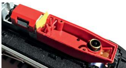
Das kleine gelbe Stückchen Reinigungstuch verhindert, dass der Propellermotor mit dem Quietschen beginnt, indem es das verdampfte Destillat vom Motorwellenöl fernhält.
