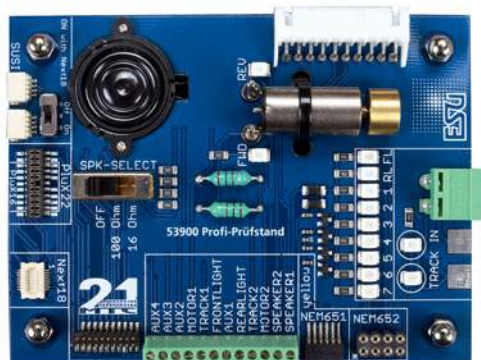
Auf der Platine mit den Abmessungen 10 cm x 7,5 cm finden sich neben den aktuellen Schnittstellen auch die klassischen nach NEM 651 und NEM 652.
