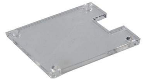
Das Acrylplättchen hat die Abmessungen und Bohrungen der originalen Decoderplatine. Mit ihm wird der Motor festgelegt und es dient der neuen Adapterplatine als Basis.
