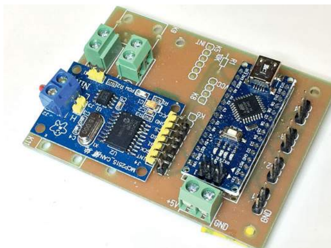
Als Vorschau auf das nächste Heft: Der fertige Weichendecoder auf der Universalplatine (60 mal 80 mm)
