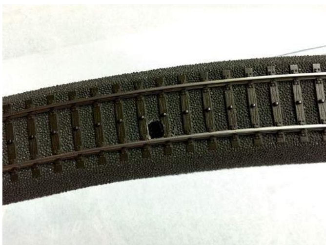
Der Hallsensor wird in das Gleis integriert. Er ist kaum wahrnehmbar und stört deshalb nur wenig.
