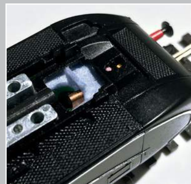
Sowohl das rosafarbene als auch das violette Stück Reinigungstuch verhindern, dass Dampfdestillat an der falschen Stelle austritt.
