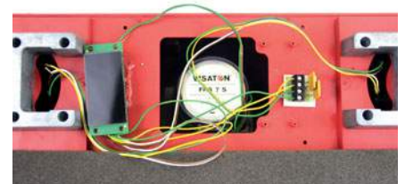
Einbau der Sicherung in einer Drehgestelllok
