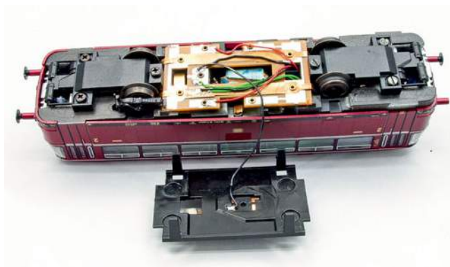
Lässt sich die Bodenplatte abnehmen. Die analoge Verkabelung wird sichtbar.
