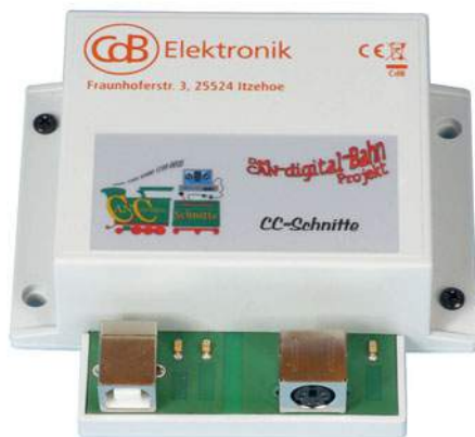
Auch die PC-Schnittstelle ist ein Gerät am CAN-Bus.
