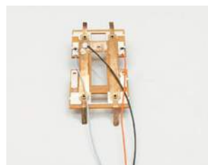
Die Schleiferplatine erhält neue Kabel.
