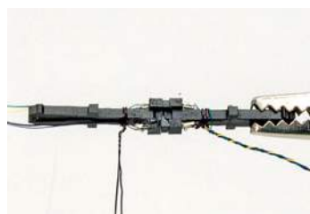
Der um den Kupplungsschaft gewickelte Draht sichert die Anschlüsse mechanisch.
