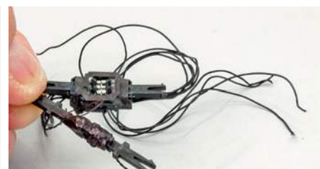
Vorne die Selbstbau-, hinten die Krois-Kupplung im Vergleich.
