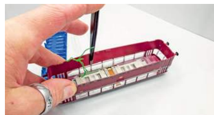
Gleichzeitiges Spreizen und Entriegeln löst die Scheiben.
