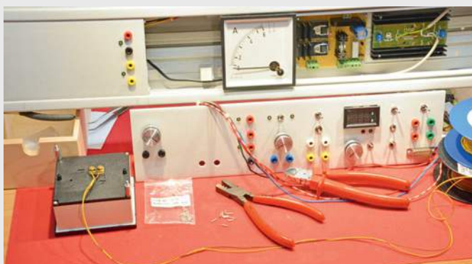
Für die Verkabelung wurden flexible Leitungen mit 0,75 mm 2 Querschnitt verwendet. Alle Kabelenden wurden mit Aderendhülsen versehen.
