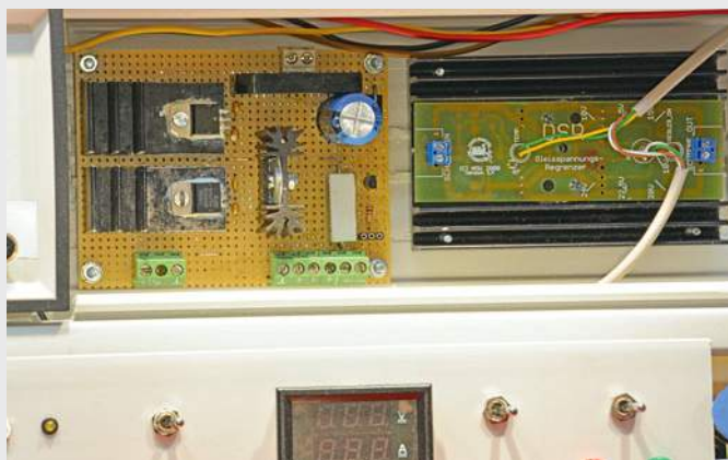
Die Stabilisierung für 5 und 12 V sowie der Fahrregler und rechts daneben das DSR zur Spannungsbegrenzung im Digitalstromkreis
