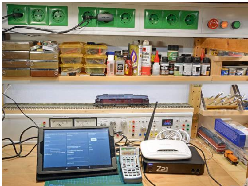
Gesamtansicht des Arbeitsplatzes. Unten ist die Teststrecke zu sehen. Darüber ein Regalbrett mit diversen Bastelmaterialien. Dieses Brett trägt an der Unterseite die LED-Beleuchtungsstreifen. Oben ist im baugleichen Kabelkanal die 230-V-Versorgung untergebracht, um die bei Tests von Digitalkomponenten oft nötigen Trafos und Netzteile zu versorgen. Am rechten Bildrand erkennt man noch die Taster für Not-Aus und Einschaltung.
