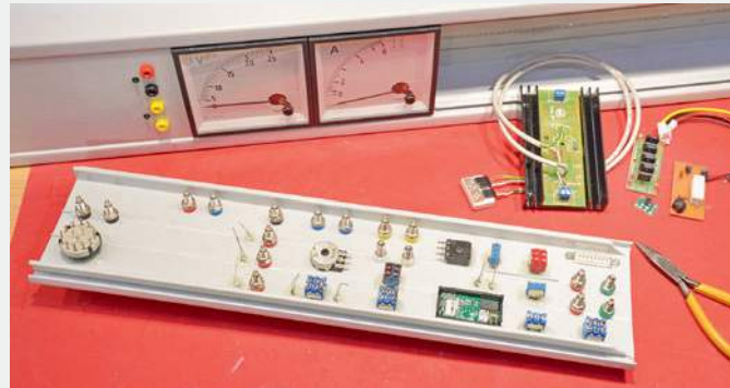
Die zahlreichen Buchsen, Schalter und LEDs werden eingebaut und als Verdrehschutz mit 2k-Kleber verklebt.
