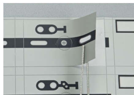
Nach dem Einsetzen der Streuscheiben werden die Segmente mit den Folien beklebt.
