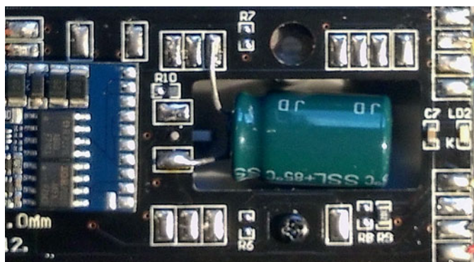
V 200: Hauptplatine mit eingelötetem Pufferkondensator und Decoderausschnitt. Über R10 kann das darunterliegende Lötpad mit Pin 9 (+) verbunden werden. + kann auch an den 3 Löt pads direkt abgegriffen werden. Am unteren verlöteten Pad liegt Masse (PIN 5) an.
