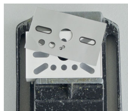
Einer kleiner Schraubstock als stabiler Untergrund beim Anbringen der Folie am Segment.
