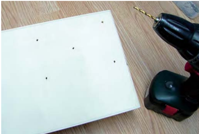
Um die Komponenten wie Basisplatine und Verteilerplatinen im Gehäuse zu montieren, müssen Befestigungslöcher in den Boden gebohrt werden.
