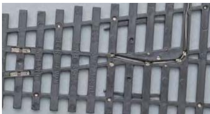
Die Unterseite einer Peco-H0-Code-75-Weiche mit dem Herzstückanschluss.
