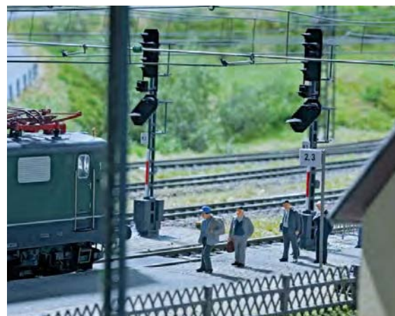
Ausfahrtsignale sind Haupt-Sperrsignale, die nicht nur Zugfahrten, sondern auch Rangierbewegungen erlauben. Gerade im Personenverkehr sind sie meist der Endpunkt einer Fahrstraße – ein Zug hält genau am Bahnsteig.
