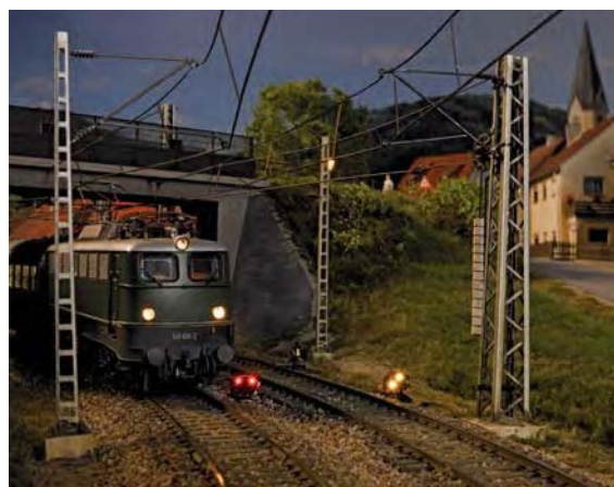
Zur Abwicklung des Rangierverkehrs genügen die relativ großen Zugfahr-Blöcke nicht immer. Eine stärkere Unterteilung gelingt mit Rangiersignalen. Die Fahrstraßen können notwendig kurz und präzise zugeteilt werden.
