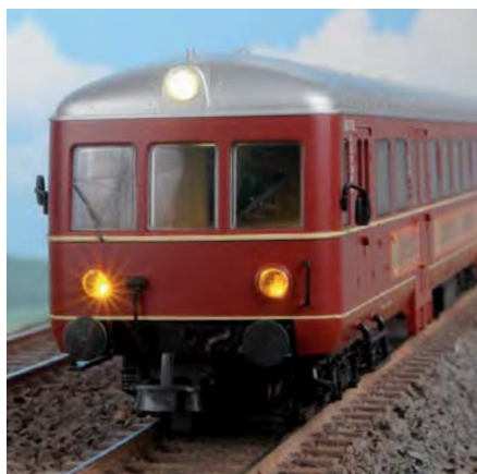
Front des Triebwagens mit teilweise getauschter LED-Beleuchtung: Sehr deutlich sind die unterschiedlichen Lichtfarben zu erkennen.
