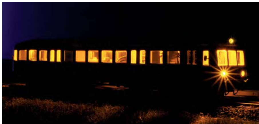
Ab Werk sind alle LEDs des Triebwagens in der gleichen gelben Leuchtfarbe ausgeführt. Trotz der Preisdifferenz zwischen gelben und weißen LEDs ist Brekinas Entscheidung für viele Modellbahner nicht nachvollziehbar gewesen. Die gelbe Beleuchtung stört den guten Gesamteindruck des Triebwagens doch empfindlich.
