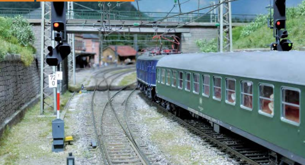
Die Einfahrtsignale sind dreibegriffig, hier mit Zusatzanzeiger. Je nach gezogener Fahrstraße zeigen sie die zulässige Geschwindigkeit an. Auch die Vorsignale zeigen passend zur Fahrstraße die korrekte Lichterkombination.
