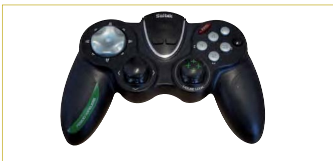
Als Steuergeräte bieten sich ein handelsübliche Gamepads an. Diese bieten neben dem komfortablen Handling und einem analogen Joystick auch die Option des kabellosen Betriebs per Bluetooth.
