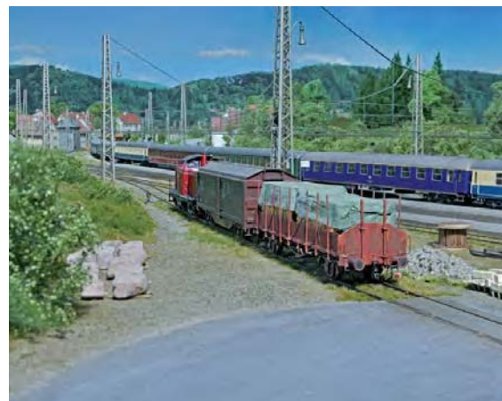
Für Nebengleise lassen sich Rangierfahrstraßen einrichten. Ist der Flankenschutz gesichert, kann hier munter rangiert werden ohne den Zugverkehr auf den Hauptgleisen zu beeinträchtigen.
