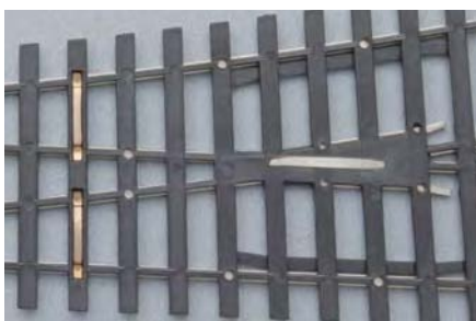
Typische Strombrücken an einer Allstrom-Weiche, hier beim Piko-A-Gleis.
