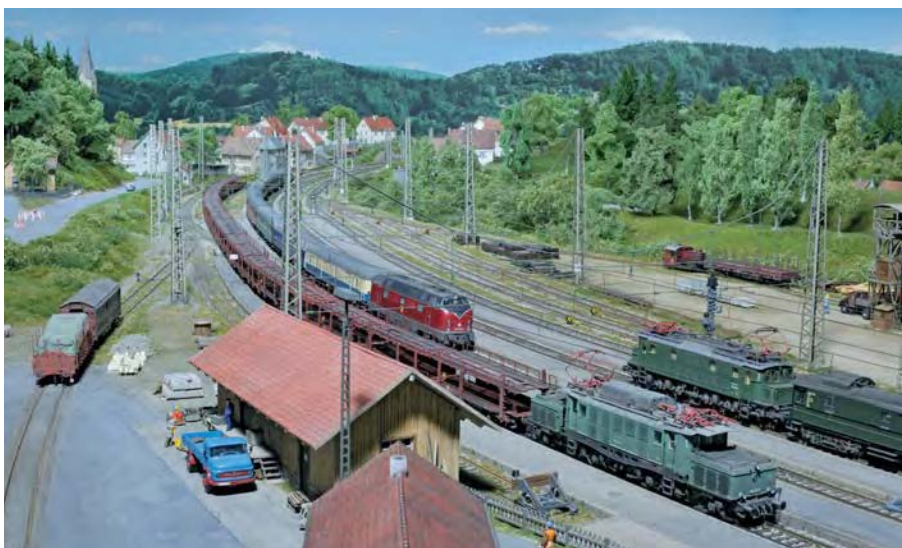
Überholung und Zugbegegnung: Die Fahrstraße des auf die Seite genommenen Güterzugs wurde aufgelöst, nachdem der Zug vor dem Signal zum Halten gekommen war. Erst dann war es möglich, für den 221-geführten D-Zug eine entsprechende Fahrstraße einzurichten.
