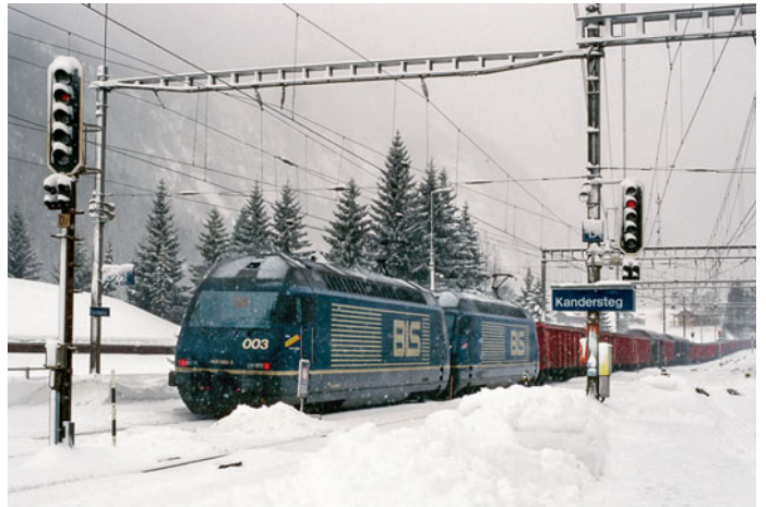
Beim Tonzug nach Italien produzieren die am Zugschluss angekuppelten Bremsloks Re 465 Energie zur Rückspeisung in die Fahrleitung. FOTO: A. SCHMUTZ
