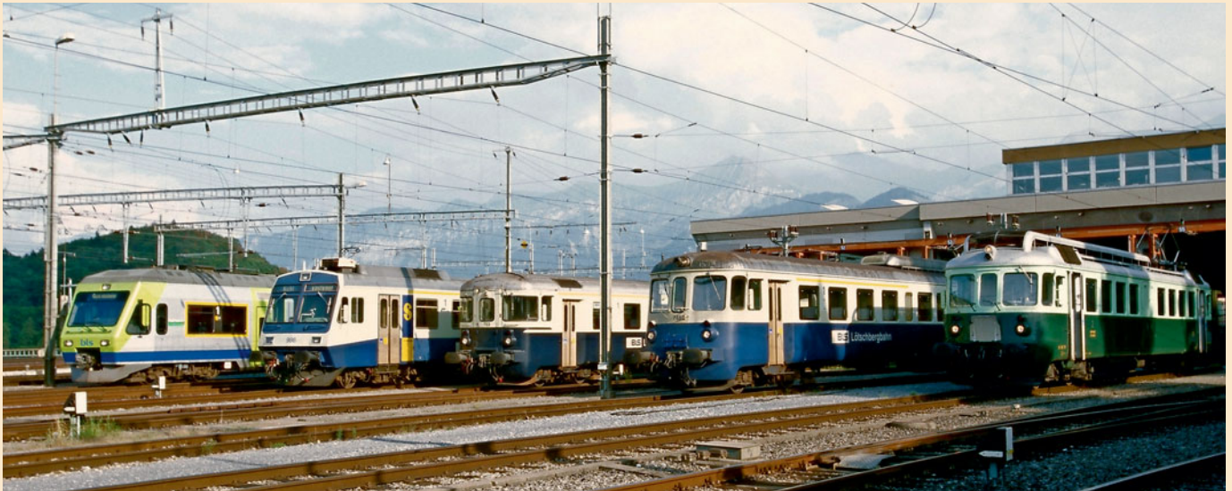
Aufstellung einiger Trieb- und Pendelzüge am 19. August 2003 in Spiez (v.l.n.r.): RABe 525 (NINA), Steuerwagen ABt Nr. 986 mit RABe 4/4-Pendelzug, ABDe 4/8 Nr. 753 und 748 und historischer Triebwagen Be 4/4 Nr. 761 „Wellensittich“.
