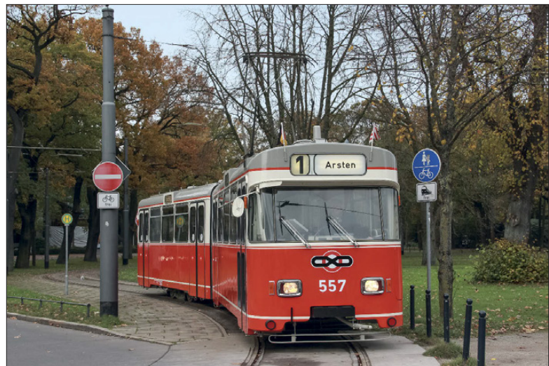
Anlässlich seiner Pressepräsentation zeigt sich der frisch aufgearbeitete Triebwagen 557 an der Domsheide in der „Landgerichtskurve“. Gut zu erkennen sind die breiten Außenschwengtüren. Die ursprünglich dazugehörigen Pendelschranken sind leider durch Lichtschranken ersetzt
