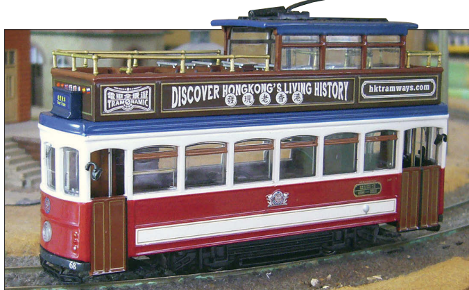
Aus Hongkong stammt dieser Doppeldecker (80M models), den Helmut Gieramm motorisiert hat. Der Stromabnehmer besteht aus Gitarrendraht
