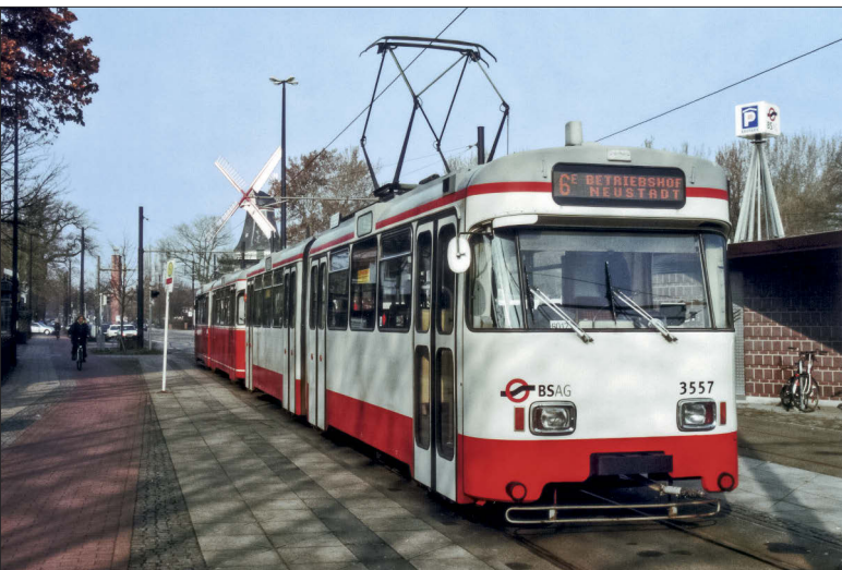
Anlässlich seiner Pressepräsentation zeigt sich der frisch aufgearbeitete Triebwagen 557 an der Domsheide in der „Landgerichtskurve“. Gut zu erkennen sind die breiten Außenschwengtüren. Die ursprünglich dazugehörigen Pendelschranken sind leider durch Lichtschranken ersetzt
