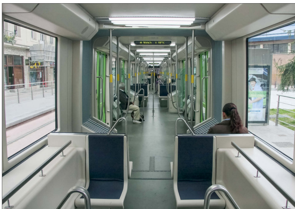
Das Wageninnere zeigt die Geräumigkeit, allerdings ist diese im Bereich der Radkästen bedingt durch die Schmalspur eingeschränkt
