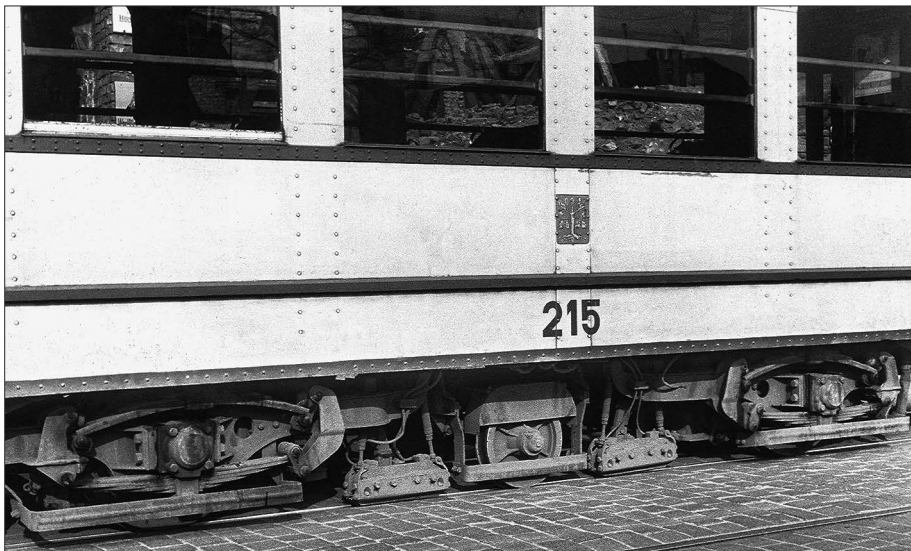
Einbaubeispiel eines Westwaggon-Lenkgestells unter einem ursprünglich zweiachsigen Triebwagen der Hagener Vorortbahn, umgebaut im Jahre 1938 COLLECTION P.H. PRASUHN, SLG. AXEL REUTHER
