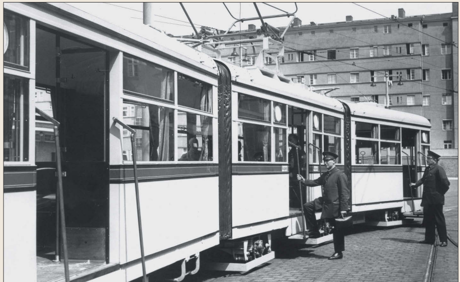
Teilsicht der Türseite. Die bei geöffneten Türen vorne und in der Mitte herausgeklappten Trittstufen aber auch eine der Lenkachsen sind gut zu sehen. Die Nottür am Heck verfügte über keine Stufen
