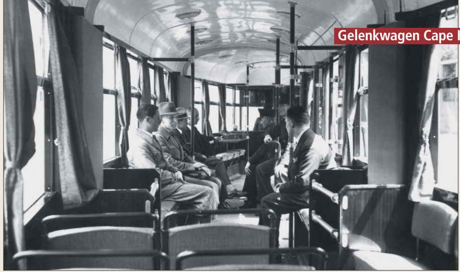
Innenansicht von hinten nach vorne mit der unterschiedlichen Sitzplatzanordnung. Auch die Verkleidung der Gelenkportale ist gut sichtbar
