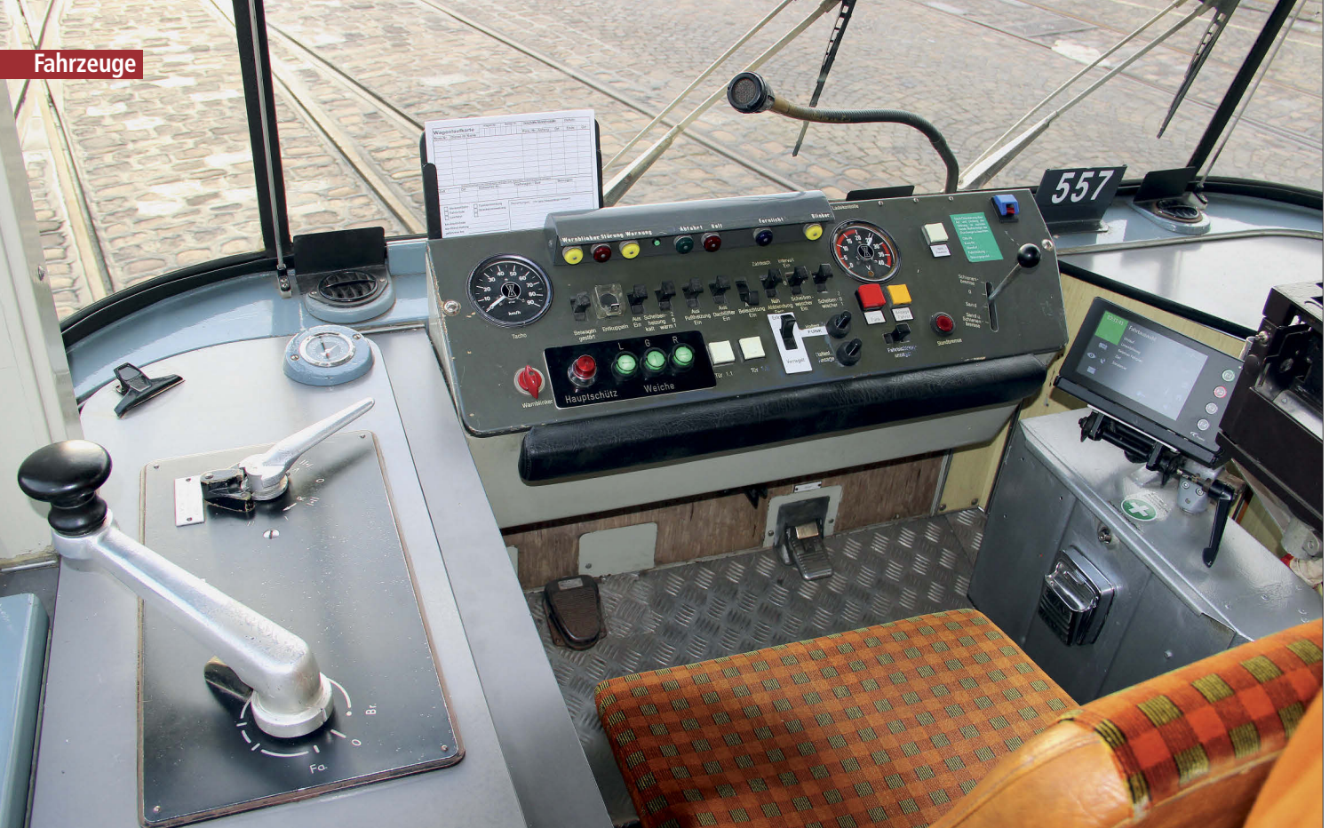
Der Fahrerplatz des Tw 557 in seinem heutigen Zustand. Moderne Zugabe sind nur der aktuelle Bordrechner und die wieder dreistellige Wagennummer. Alles andere ist noch genau so wie in den letzten Einsatztagen im Liniendienst
