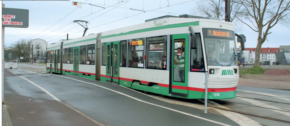
Die provisorisch barrierefreie Haltestelle im Adelheidring wurde geschaffen, um mobilitäts-eingeschränkten Fahrgästen einen Zugang vom und zum Hbf. zu gewährleisten. Der erhöhte Teil umfasst die ersten beiden Niederflureinstiege bei den NGTs
