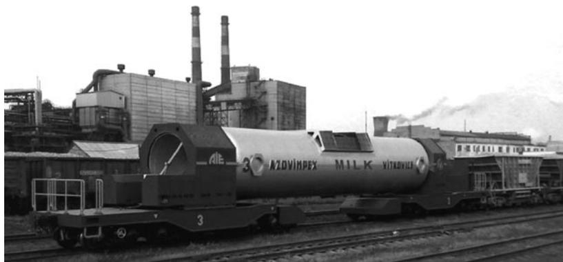
Рис. 11.30. Транспортер 16-осный сочлененного типа
