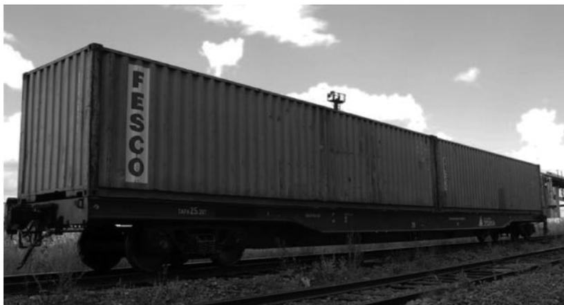
Рис. 11.24. Четырехосная длиннобазная платформа модели 13-1281 для перевозки крупнотоннажных контейнеров: грузоподъемность 69 т, масса тары 25 т, длина по осям сцепления 25 720 мм, база вагона 19 700 мм, нагрузка на ось 23,5 тс
