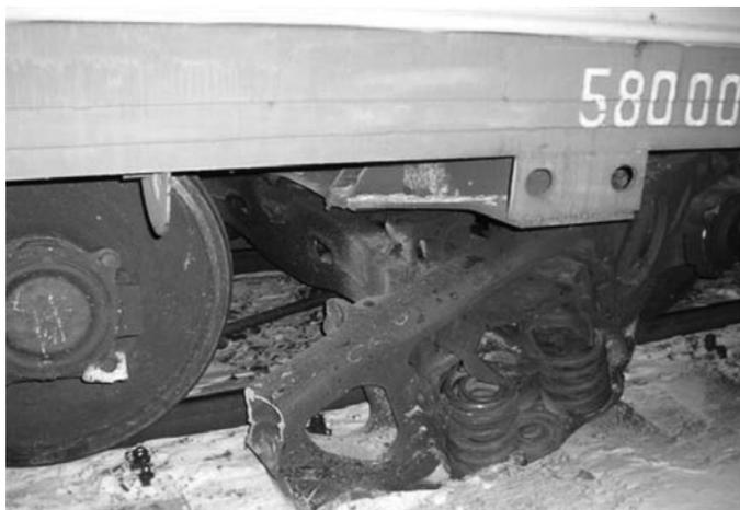
Рис. 15.3. Излом боковой рамы тележки в буксовом проеме, повлекший сход вагона в составе грузового поезда
