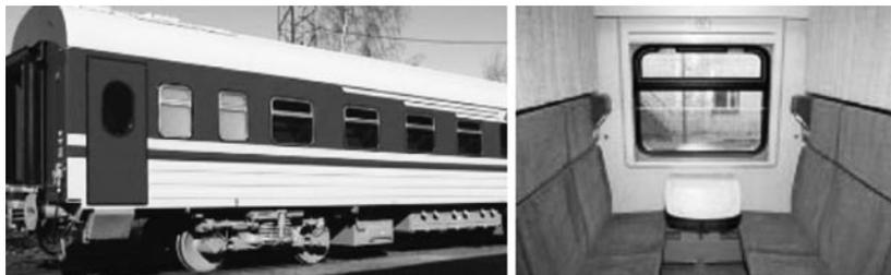
Рис. 12.4. Общий вид и внутреннее оборудование пассажирских купейных вагонов серии «сорок четыре сорок»
