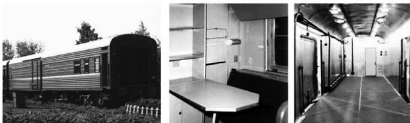
Рис. 12.6. Общий вид и внутреннее оборудование вагона багажного модели 61-4185
