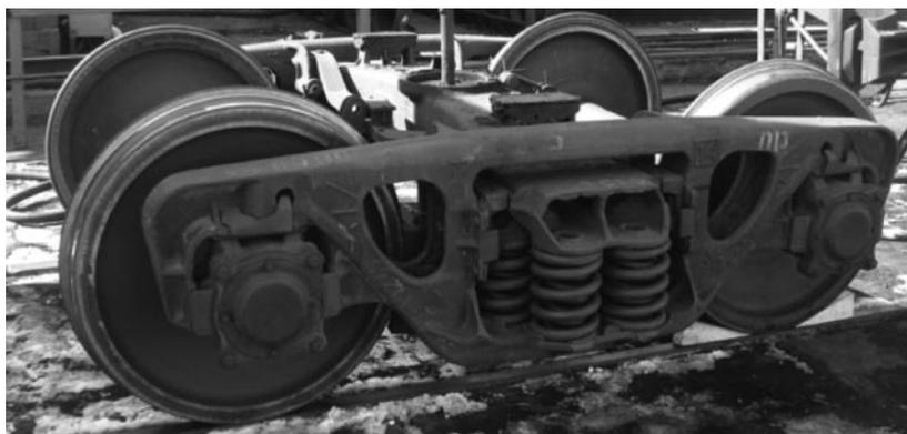
Рис. 8.5. Тележка модели 18-100, модернизированная по проекту М1698 ПКБ ЦВ с установкой износостойких элементов в узлах трения
