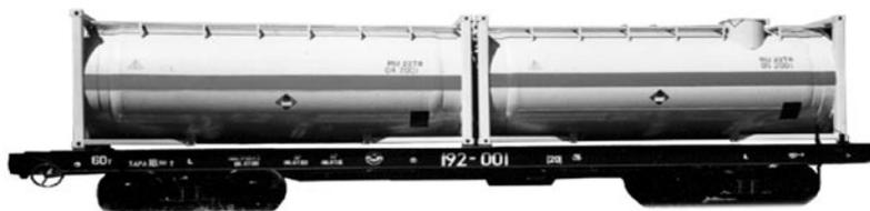
Рис. 11.27. Четырехосный вагон-цистерна модели 15-160 для перевозки олеума
