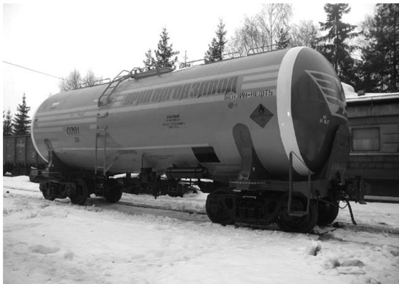
Рис. 11.16. Четырехосный вагон-цистерна модели 15-566 без хребтовой балки для перевозки бензина и бензиновой фракции
