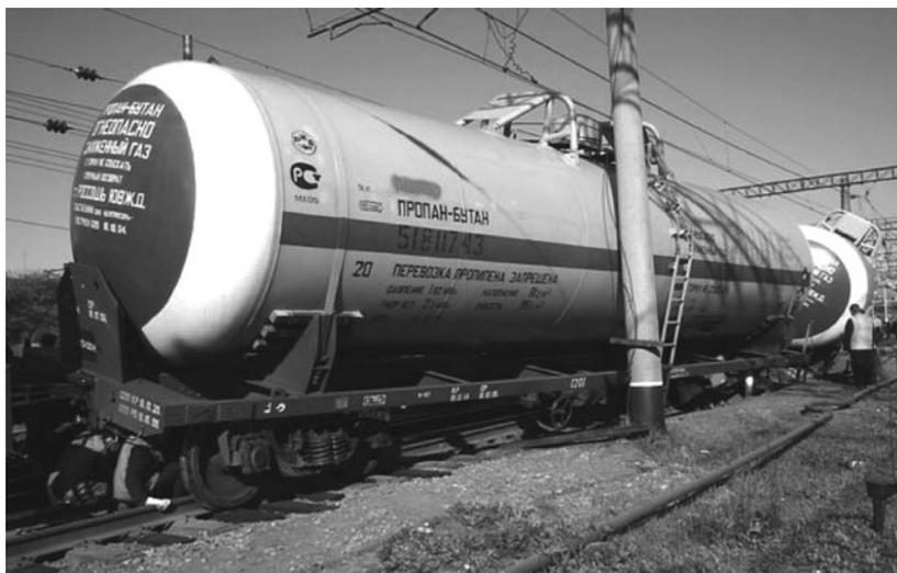
Рис. 15.1. Сход цистерн с опасным грузом в составе грузового поезда
