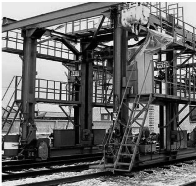
Рис. 13.3. Общий вид вагоноремонтной машины «Волжанка»
