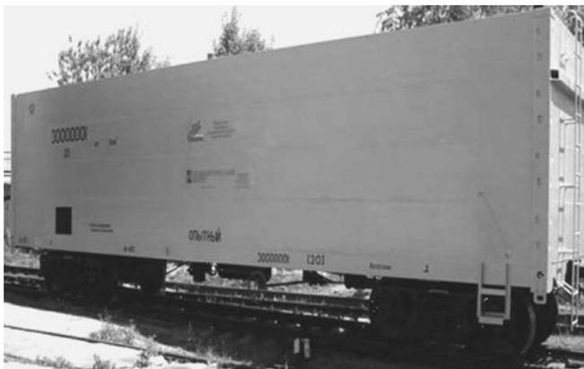
Рис. 11.12. Четырехосный цельнометаллический универсальный полувагон с кузовом из алюминиевых сплавов. Производитель – ОАО «Воронежское акционерное самолетостроительное общество», грузоподъемность – 82 т, масса тары – 18 т, объем кузова – 100,5 м<sup>3</sup>, нагрузка на ось – 25 тс
