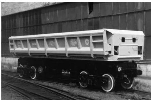
Рис. 11.31. Четырехосный думпкар (вагон-самосвал) модели 32-4079 производства ОАО «Днепровагонмаш»
