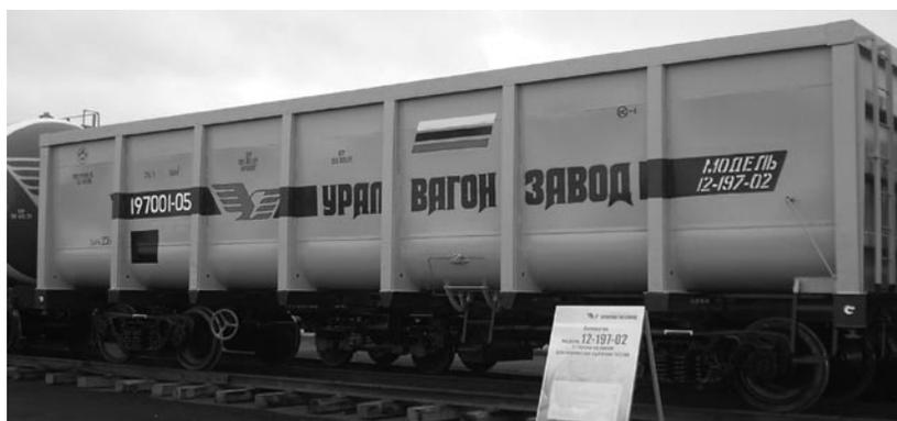
Рис. 11.10. Четырехосный цельнометаллический универсальный полувагон с глухим кузовом модели 12-197-02 с осевой нагрузкой 25 тс
