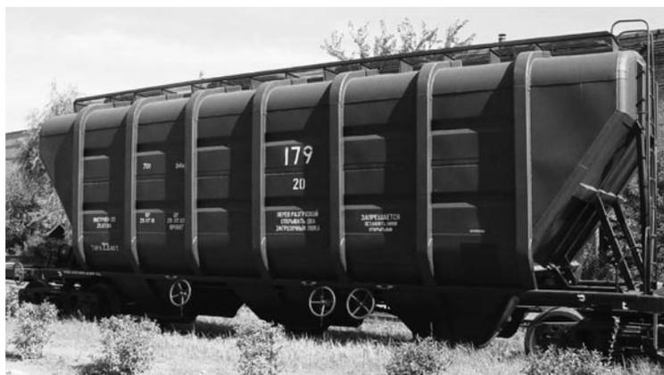
Рис. 11.20. Современный специализированный вагон модели 19-4109 для перевозки зерна. Производитель – ОАО «Днепровагонмаш»
