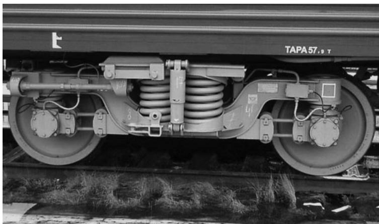
Рис. 8.14. Пассажирская тележка безлюточного типа с системой дискового торможения
