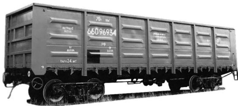
Рис. 11.8. Четырехосный цельнометаллический универсальный полувагон с глухими торцевыми стенами модели 12-132-03
