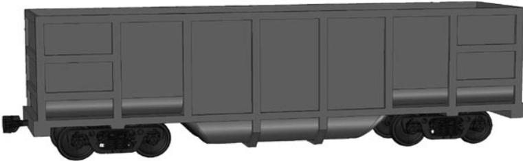
Рис. 11.22. Полувагон с глухим кузовом без хребтовой балки с нагрузкой от колесной пары на рельсы 27 тс. Грузоподъемность 83 т, масса тары 25 т, длина по осям сцепления 12 100 мм
