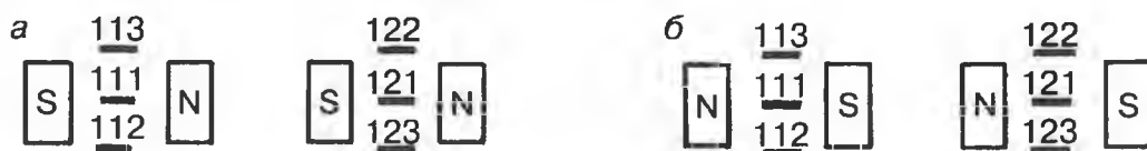
Рис. 151. Расположение полюсов магнитов дугогашения в реле: а — СКНР2; б — СКНР3
