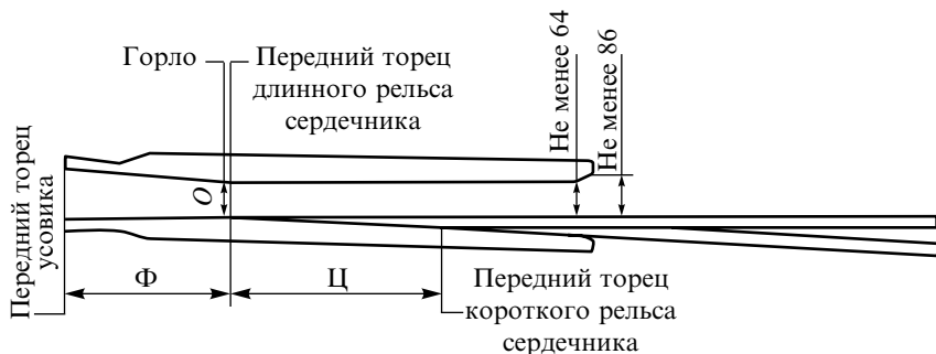
Рис. 5.63. Места контрольных измерений ширины желобов в тупых крестовинах
