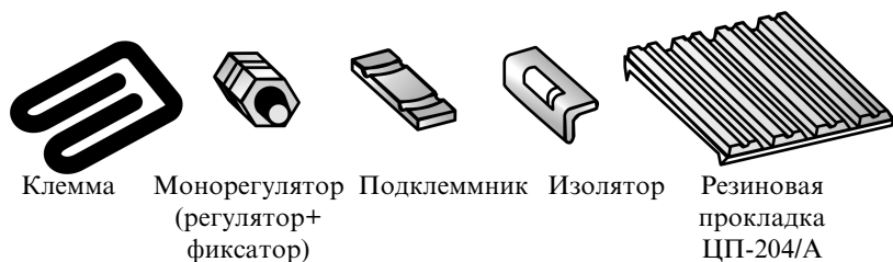
Рис. 5.16. Съемные элементы узла промежуточного рельсового крепления АРС-4
