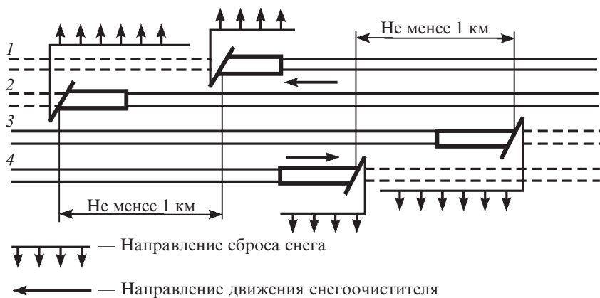
Рис.10.5. Схема очистки путей от снега на четырехпутном участке (1, 2, 3, 4)
