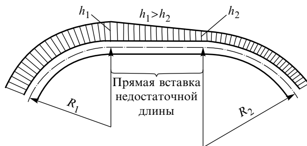
Рис. 6.9. Схема отводов возвышения наружной рельсовой нити при сопряжении кривых одного направления при недостаточной длине прямой вставки между ними
