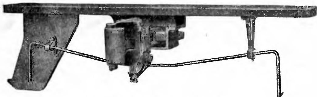
Фиг. 26. Пассажирская автосцепка Питт на вагоне.
