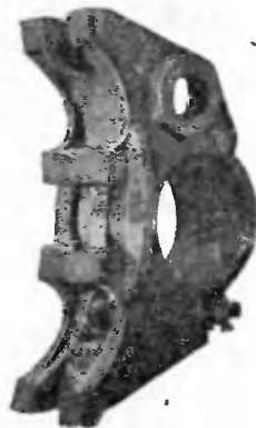
Фиг. 223. Устанавливающийся башмак Баффало.
