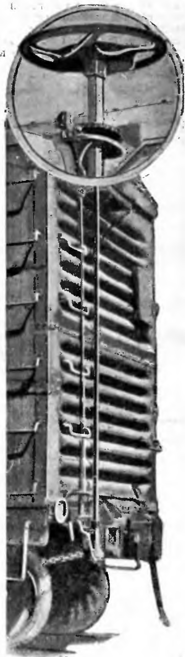
Фиг. 259. Ручной тормоз с вертикальным валом и маховиком.
