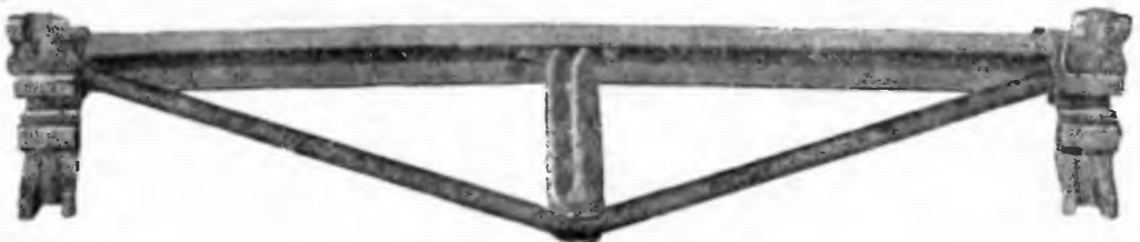
Фиг. 212. Триангль Аякс для товарного вагона.
