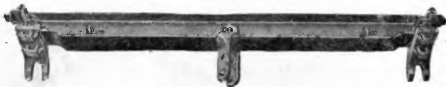
Фиг. 213. Тормозная балка (триангль) двугаврового сечения для товарных тележек с короткой базой.
