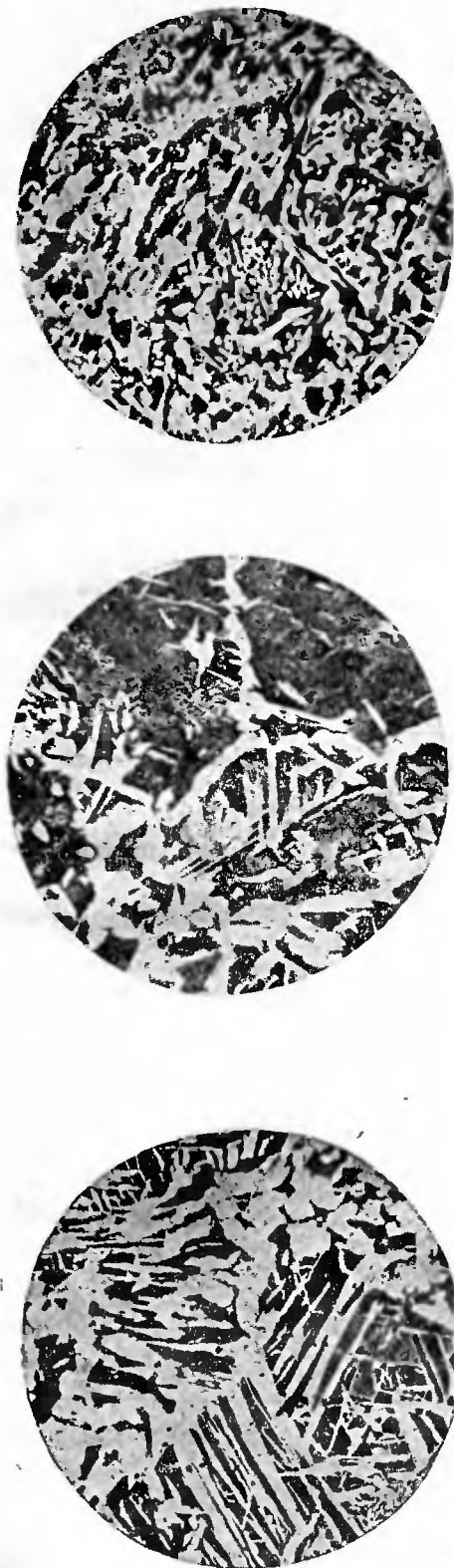
Фиг. 3. Шлифы стали после недолгого (неполного отжига). Увеличено в 100 раз.
