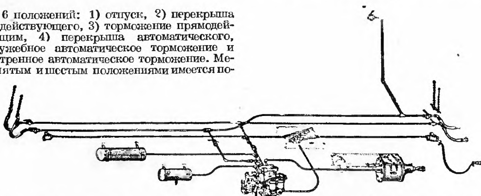
Фиг. 189. Тормозное универсальное воздушно-электрическое оборудование типа ATUE для пассажирских вагонов.
