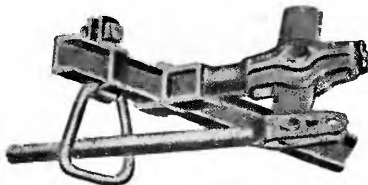
Фиг. 246. Предохранительная поддержка нижней соединительной тяги.
