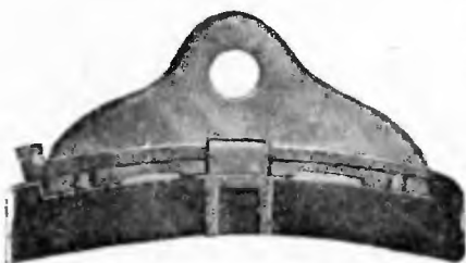
Фиг. 206. Комбинированный башмак для движущих колес, с колодкой.
