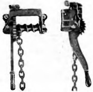
Фиг. 271. Ручной тормоз с рычагом и храповиком.
