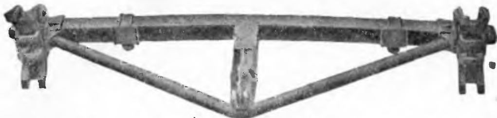
Фиг. 214. Триангль Геркулес с самоустанавливающимися башмаками для двухосной пассажирской тележки.
