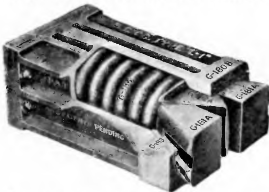
Фиг. 91. Поглощающий аппарат Сешонс-Стандарт L. правильной длины состоянии готовы для установки на вагон и имеют пружины под надлежащим начальным нажатием. Это начальное нажатие заставляет все трущиеся поверхности быть всегда в плотном соприкосновении и готовыми встретить удар. Начальное нажатие пружин автоматически компенсирует всякий износ трущихся поверхностей, который может иметь место во время жизни аппарата. Аппа-
