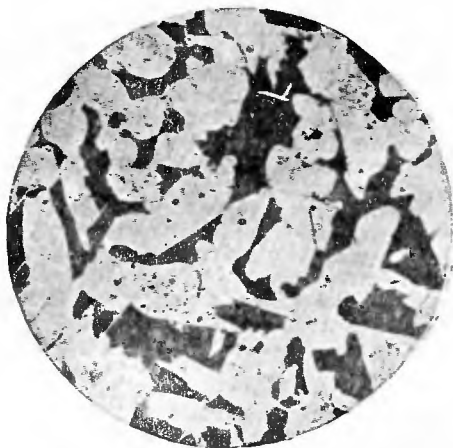
Фиг. 2. Шлифы стали после перегрева (перегрева). Увеличено в 100 раз
