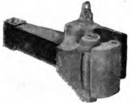
Фиг. 35. Автосцепка Пенн.
