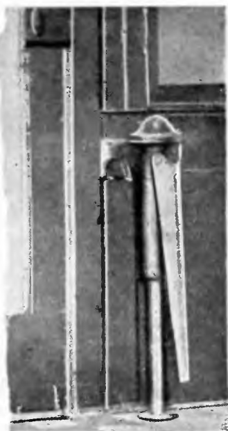
Фиг. 266. Ручной тормоз с откидным рычагом и храповиком в пассажирском вагоне.
