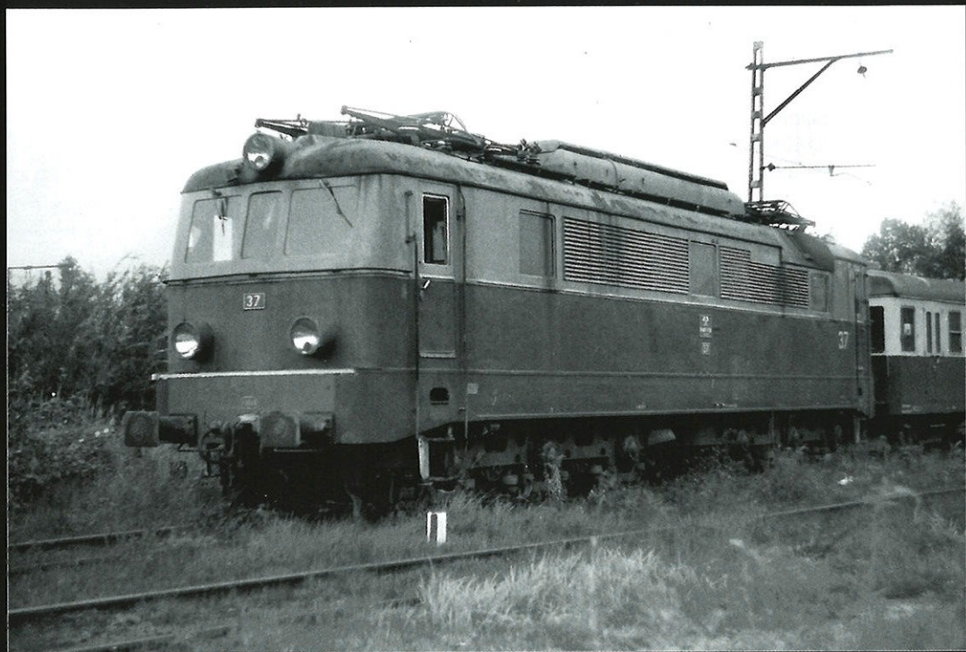
Jęzor. 3E/1-37 z pozostałością po bocznych pantografach używanych na polach piaskowych. 07.10.1994 r
