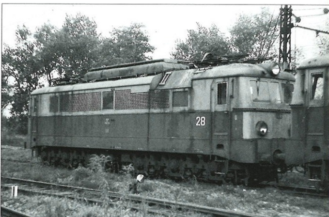
Jęzor. 3E/1-28 z pozostałościami po bocznych pantografach używanych na polach piaskowych. 07.10.1994 r
