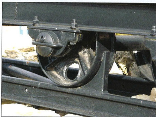
Szczegóły konstrukcyjne koleby: sposób montażu koła ze smarownicą oraz mechanizm wywrotnicy. 15.08.2016 r.
