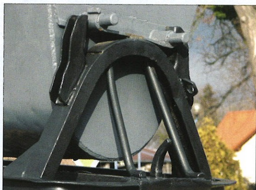
Szczegóły konstrukcyjne koleby: sposób montażu koła ze smarownicą oraz mechanizm wywrotnicy. 15.08.2016 r.
