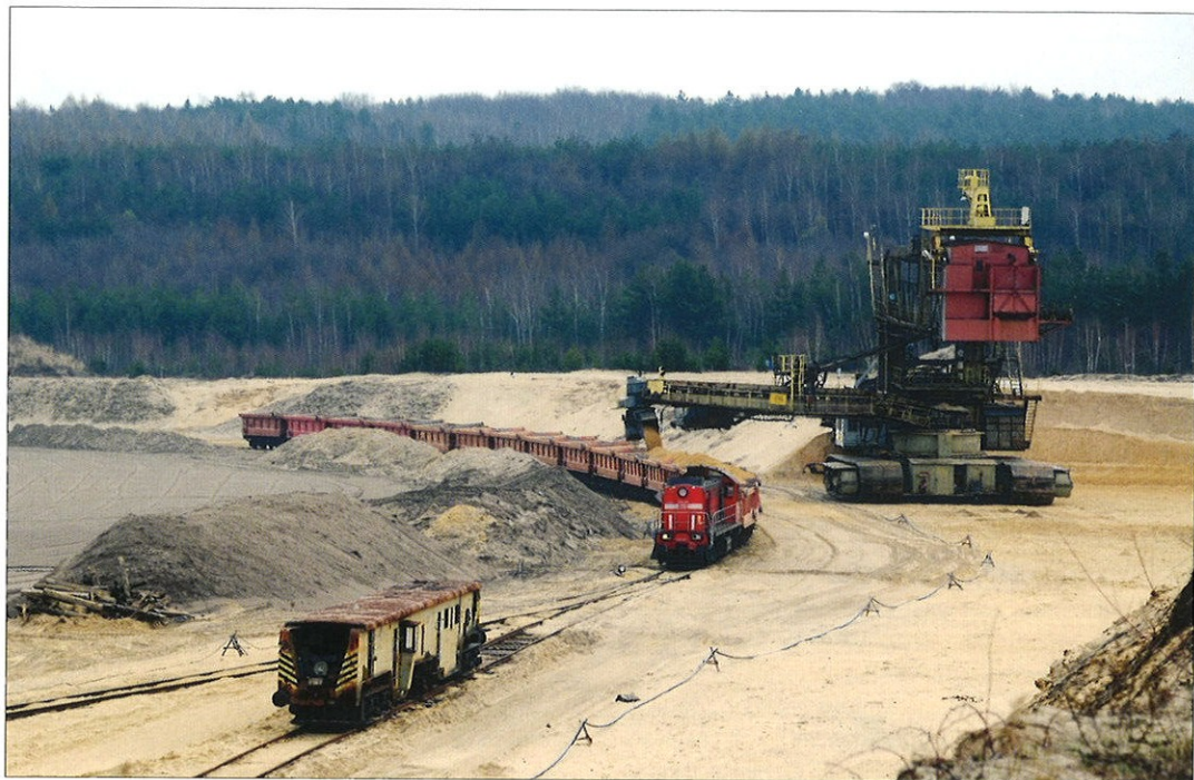
Skład „automatów” z TEM2-025 na czole czeka na zakończenie załadunku na polu piaskowym Ciężkowice. Przed pociągiem widoczna przesuwarka do torów. 30.03.2017 r.
