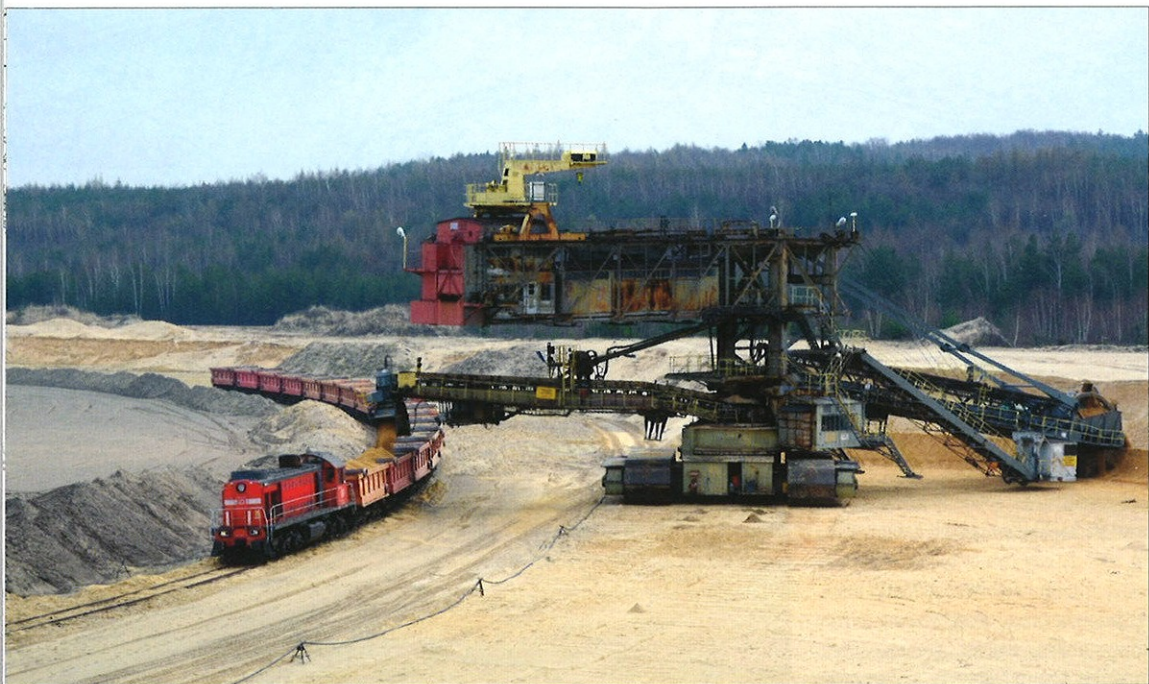
Lokomotywa TEM2-025 ze składem wagonów rolkowych podczas załadunku na polu piaskowym Ciężkowice. Widoczna koparka SchRs-470. 30.03.2017 r.
