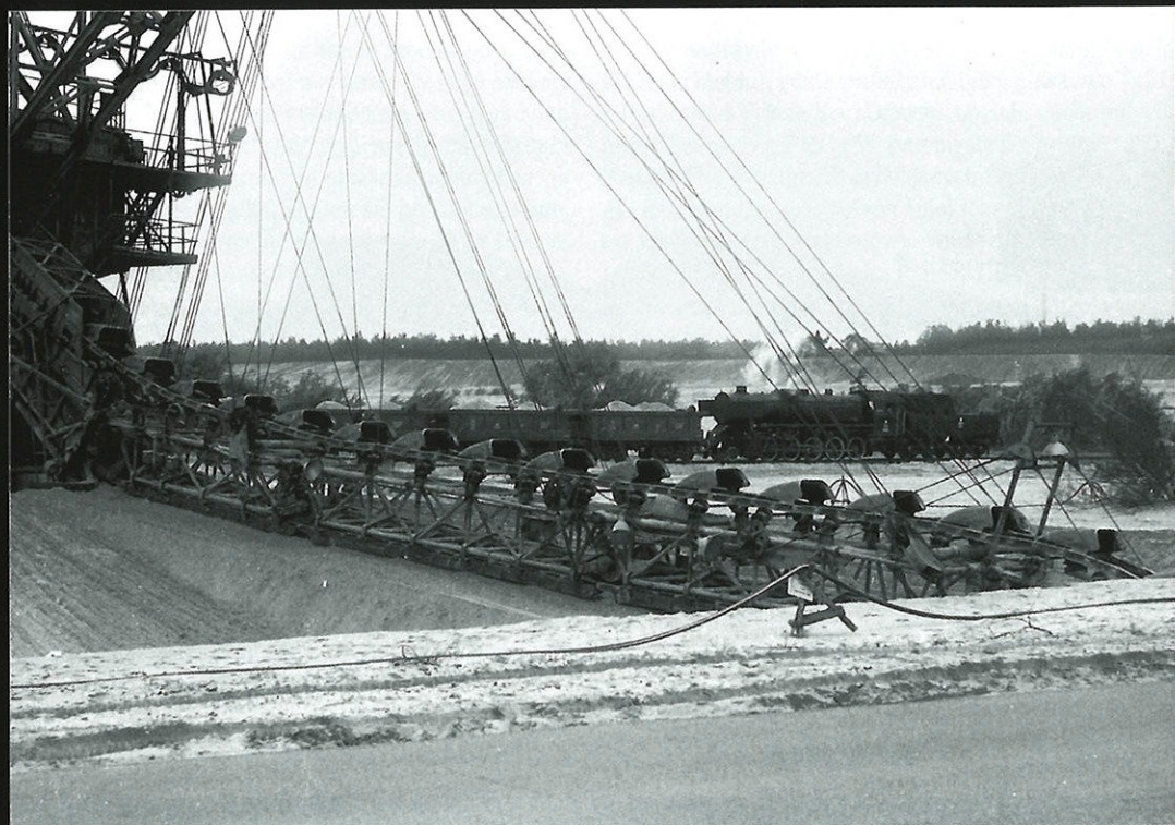
Ty2-5680 na polu piaskowym w Bukowni. Na pierwszym planie ramię koparki wielonaczyniowej, kroczącej typu RK-400. 07.10.1994 r.
