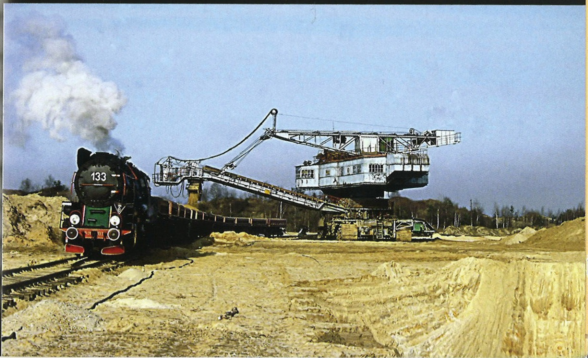
Pociąg kolei piaskowych podczas załadunku surowca na polu piaskowym Kotłarnia. Parowóz Ty51-133 ze składem „dumpcarów” i koparką wielonaczyniową Rs-500. 10.04.1992 r.
